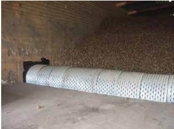
Abb. 5: Quer zur Einlagerungsrichtung angeordneter Oberflurkanal zur Luftverteilung im Kartoffelstapel (Foto: Peters)
