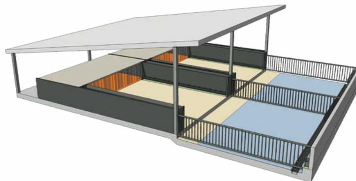
Abb. 11: 3D-Ansicht von Zweiklimabuchten für je 40 Aufzuchtferkel mit Fütterung außerhalb der Liegekiste (© KTBL, K. Neumann)
