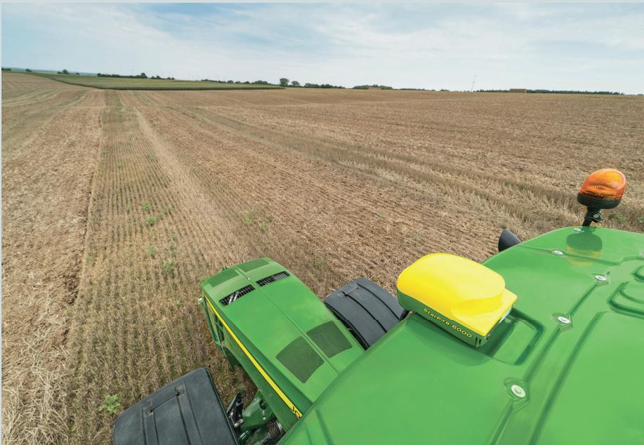
Abb. 10: GPS-Empfänger auf Traktor
