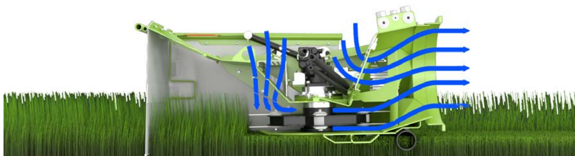
Abb. 12: Da die Luft gezielt von oben zugeführt wird und der Boden unter dem Schneidwerk weitestgehend geschlossen ist, gelangen weniger Lebewesen in den Mähkopf (© MULAG Fahrzeugwerk Heinz Wössner GmbH u. Co. KG.)
