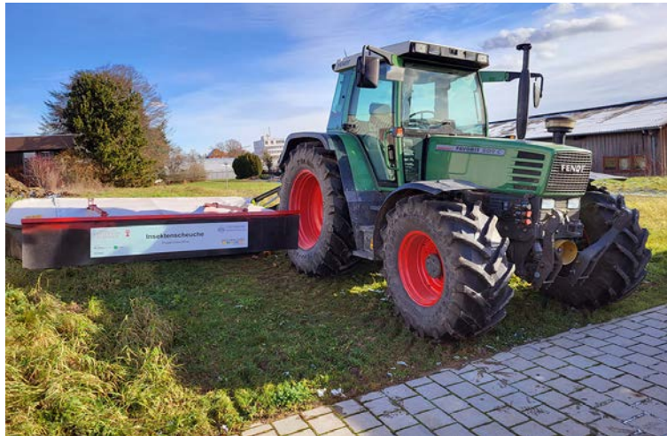
Abb. 9: Im Projekt „InsectMow“ eingesetzte Insektenscheuche als Prototyp; ein mit Auslegern am Mähwerk befestigter Vorhang schlägt die Insekten rechtzeitig in die Flucht (© J. Frank)
