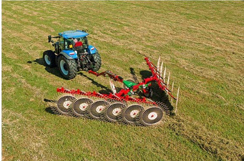
Abb. 5: Sternradschwader mit zentraler Ablage: hohe Flächenleistung, sauberes Erntegut sowie geringe Ernteverluste durch die gute Anpassung an die Bodengegebenheiten (© enorossi)
