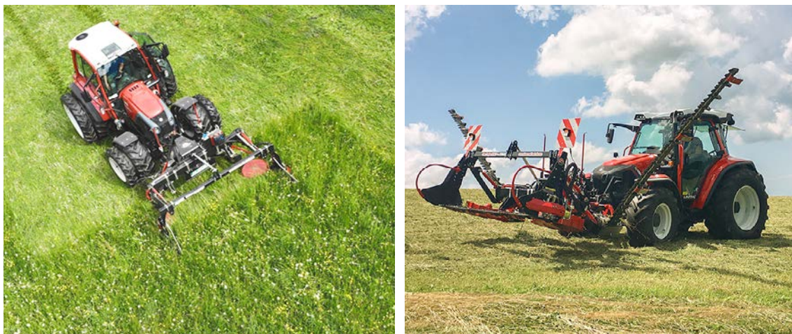
Abb. 2: Doppelmessermähbalken – im Frontanbau (linkes Bild) sowie im aus- und hochgeklappten Zustand (rechtes Bild) (© BB Umwelttechnik GmbH)
