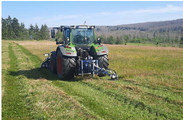
Abb. 3: Neben Frontmähdwerken (siehe Abb. 2) sind auch Heckmähdwerke auf dem Markt verfügbar (© KEMA – Kersten Maschinenfabrik)
