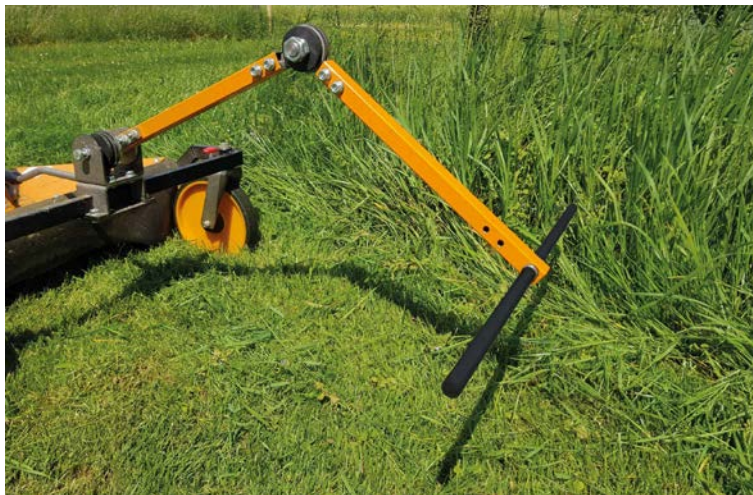
Abb. 10: Die mit einem Ausleger am Mähwerk befestigte Streifstange scheucht Insekten auf, bevor die Messer greifen (© AriensCo GmbH)
