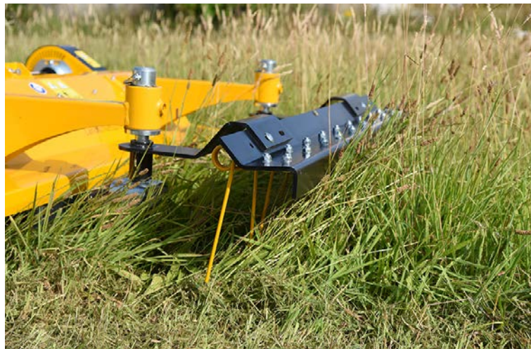
Abb.13: Insektenscheuchvorrichtung der Firma Müthing GmbH & Co. KG als Zusatzausstattung bei Mulchern (© Müthing GmbH & Co.KG)
