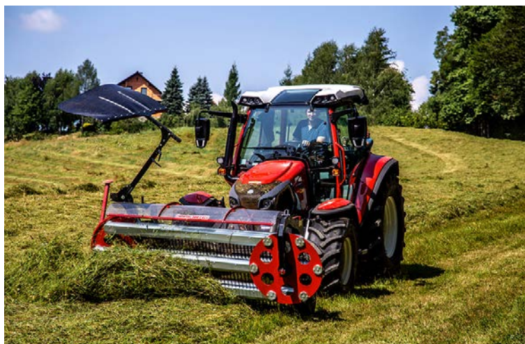
Abb. 4: Bei Kammschwadern wird das Erntegut mit an Scheiben befestigten Kämme schonend ins Schwad gelegt (© BB Umwelttechnik)
