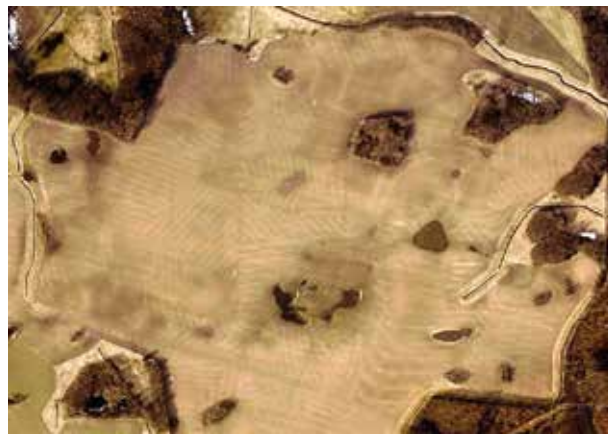
Abb. 5: Luftbildsichtbare Drainageanlagen, Aufnahme vom 10.03.2019 (© G. Grenzdörffer)
