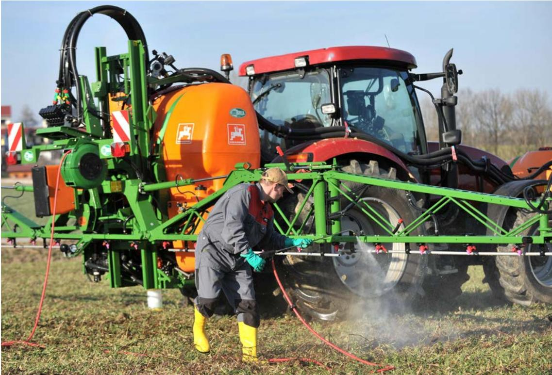
Abb. 5: Reinigung einer Pflanzenschutzspritze auf dem Feld (© agrarfoto.com)
