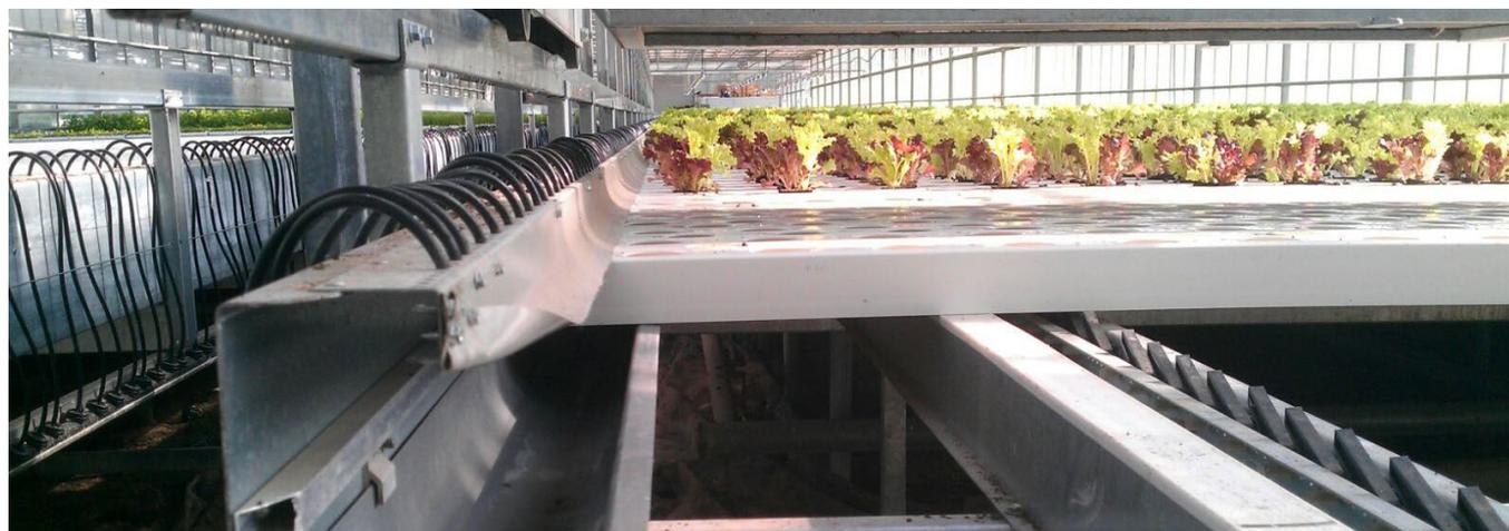
Abb. 8: Wasserzuführung eines mobilen Rinnensystems (© N. Domurath)
