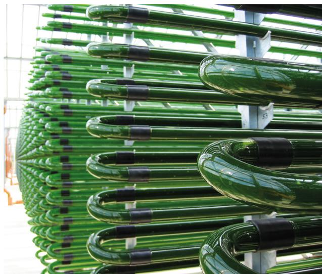
Abb. 6: Hochtechnisierte Röhrenreaktoren zur Produktion im Gewächshaus (© Roquette Klötze GmbH & Co. KG)
