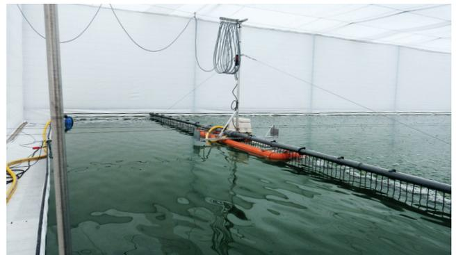
Abb. 15: Im Gewächshaus installiertes H-System der NOVAgreen (Open-Pond-System) mit Belüftungskamm (© R. Lüttmann)
