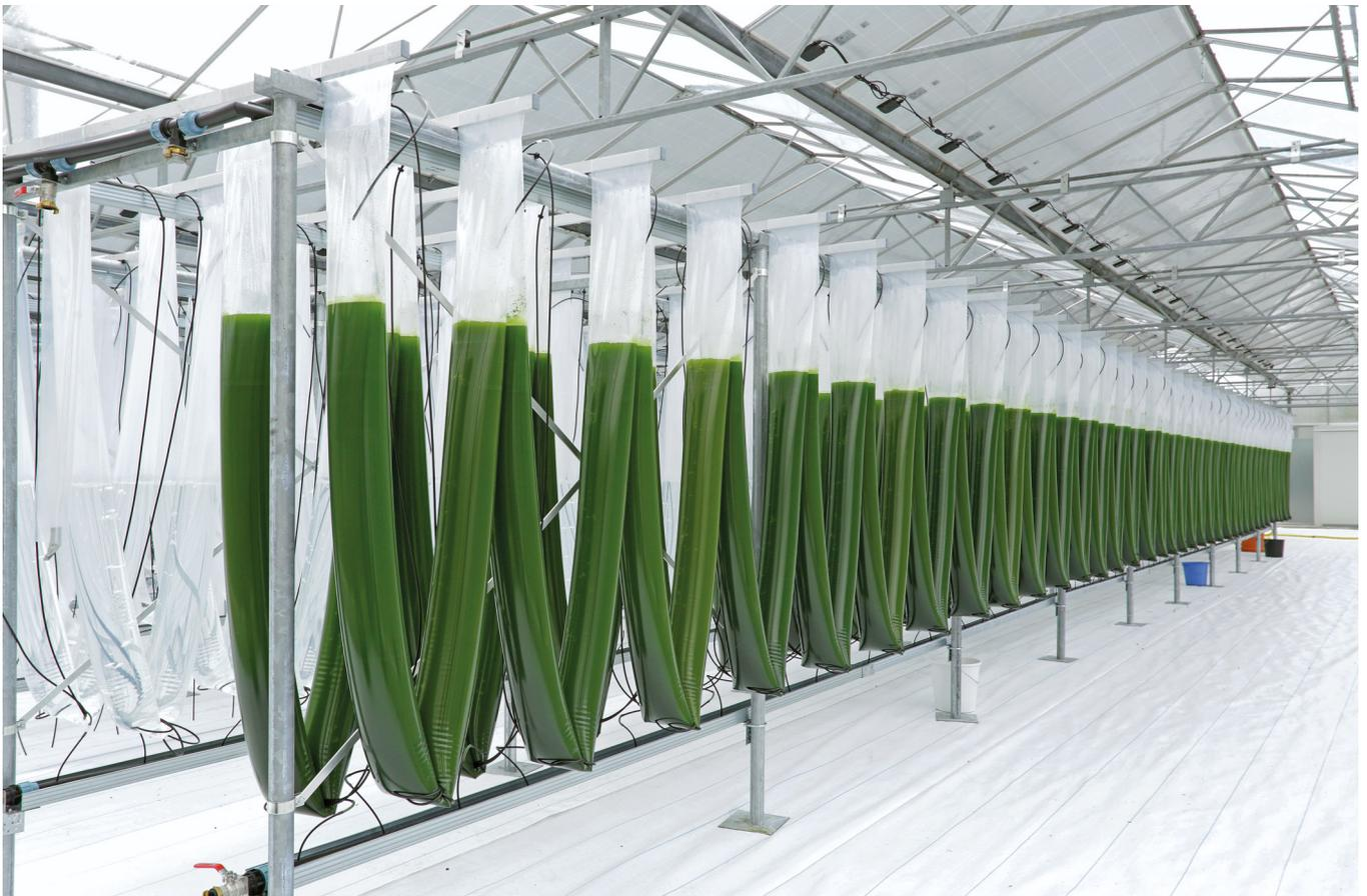
Abb. 10: V-Schlauchsystem der NOVAgreen zur Anzucht von Stammkulturen und zur Technologieentwicklung mit einer Luft/CO<sub>2</sub>-Zufuhr von unten durch eingestochene Kanülen (© Forschungszentrum Jülich GmbH/IBG-2)
