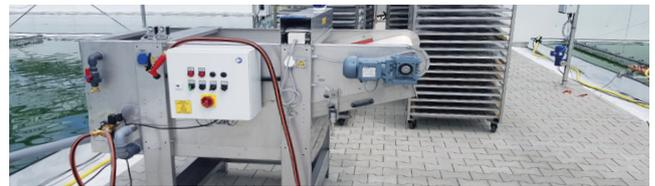
Abb. 16: Neu entwickelte Erntetechnik für Zellgrößen ab 5 µm mit einer Leistung von 12 m<sup>3</sup>/h (© NOVAgreen)
