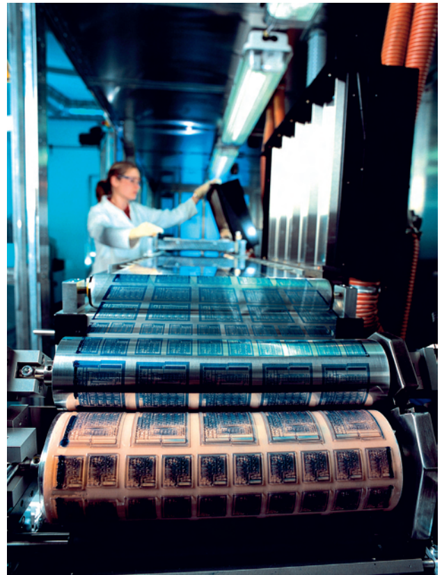
Abb. 8: Herstellung von polymeren Elektronikschaltungen über Druckverfahren Foto: PolyIC GmbH & Co. KG [21]
