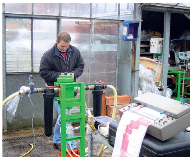
Abb. 12: Dosiergerätekontrolle im Praxisbetrieb mit Schreiber zur Dokumentation der Ergebnisse
