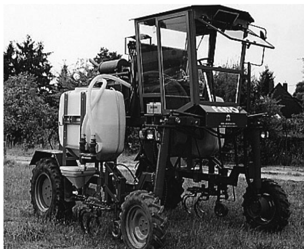
Abb. 7: Allradversion des Febo 15.60 mit Reihengrubber im Spurbereich.
