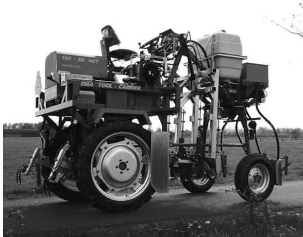
Abb. 8: SMA Tool-Carrier mit Einrichtungen zur Reihendüngung und abgeschirmten Spritzung.
