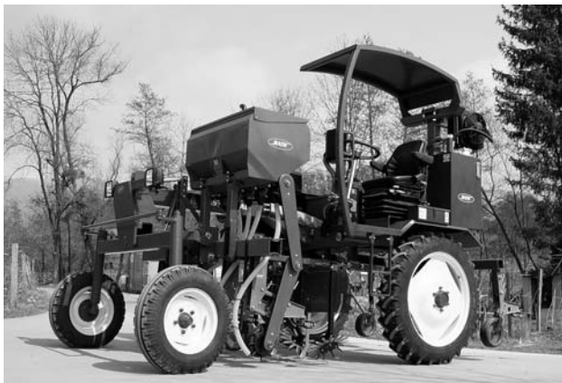
Abb. 3: Mastertrac (Hinterradversion) mit Düngeeinrichtung und Fingerhacke im Zwischenachsbanau.
