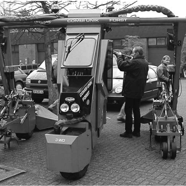
Abb. 13: Ansicht des dreirädrigen Combi Unik Forst mit Grundausstattung zur mechanischen Bodenbearbeitung.
