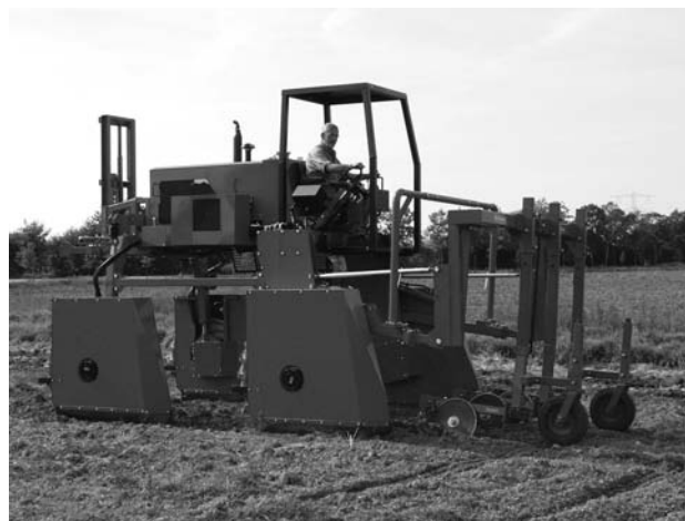
Abb. 6: Multitrac MT 55TD-4wd mit Häufelscheiben-Aggregat im Frontanbau.
