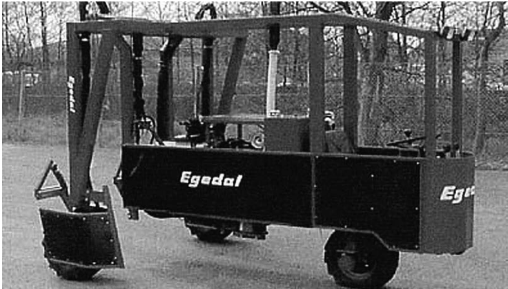
Abb. 13: Ansicht des dreirädrigen Combi Unik Forst mit Grundausstattung zur mechanischen Bodenbearbeitung.
