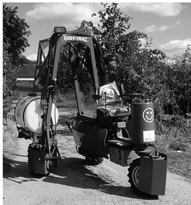
Abb. 10: Easy-Trac mit Spritzbrühfass für abgeschirmtes Spritzen.
