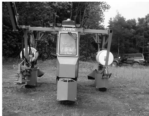
Abb. 9: Flex-Trac mit Grundausrüstung zur Spritzung.
