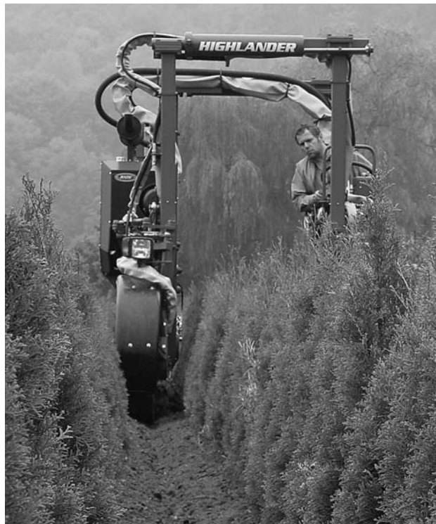
Abb. 4: Highlander V 70 bei der Bodenbearbeitung in Reihenzwischenräumen.
