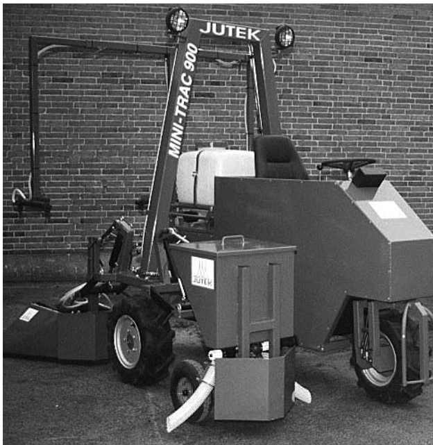
Abb. 11: Mini-Trac mit Reihendünggeeinrichtung und Unterblatt-Spritzeinrichtung.
