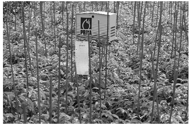
Abb. 2: Klimabox eines Klimacomputers. Die Überwachung des Fühlers über die Software (Plausibilitätsprüfung) bieten nicht alle Hersteller an.
