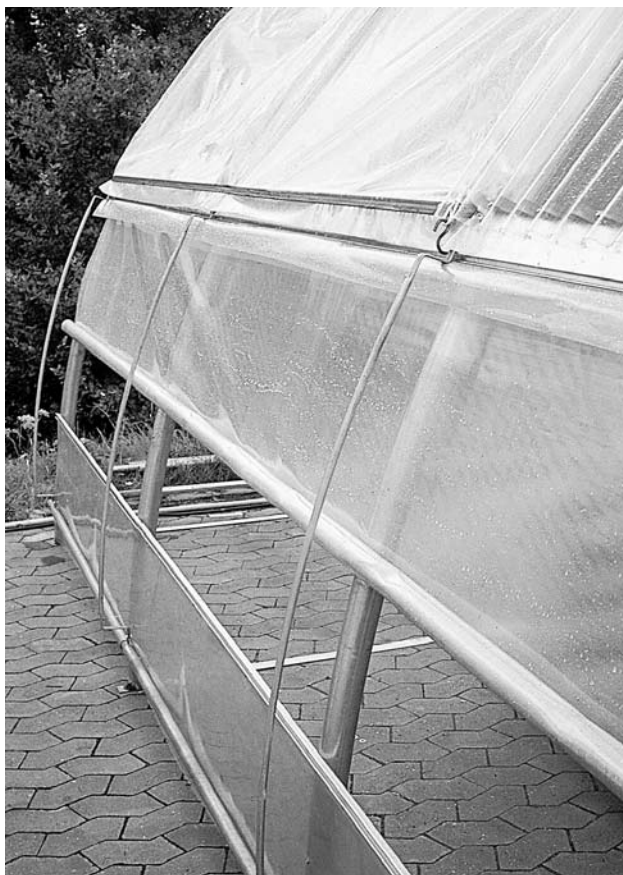
Abb. 4: Aufrollbare Stehwandlüftung mit Folienschürze
