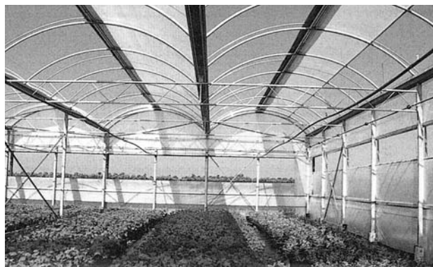
Abb. 6: Offendach-Folienhaus mit aufrollbarem Dach und Stehwandlüftung von oben nach unten Werkbild: Rovero
