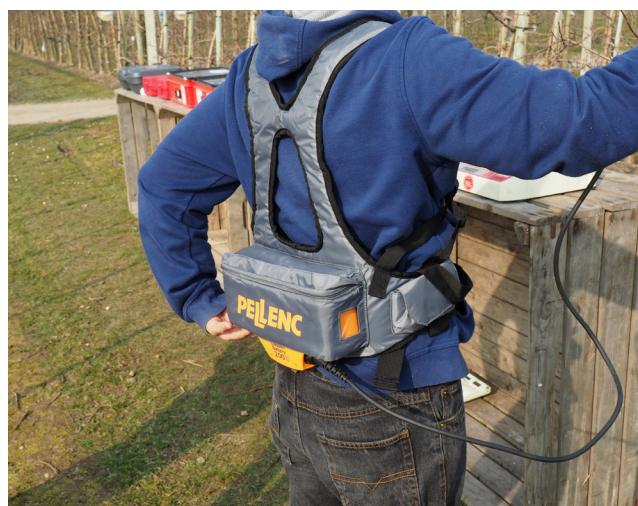
Abb. 3: Das Gewicht des Akku-Rucksacks wird auf dem Rücken verteilt und lässt viel Bewegungsfreiheit (Quelle: Wicke)
