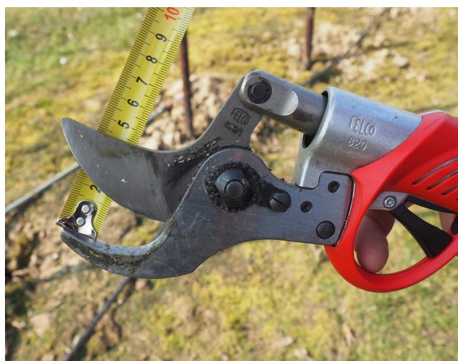
Abb. 1: Die übliche Schnittweite, die im Halböffnungsmodus eingestellt werden kann, beträgt 30 mm. Dies erlaubt eine schnelle Schnittgeschwindigkeit bei dünnen Ästen. (Quelle: Wicke)
