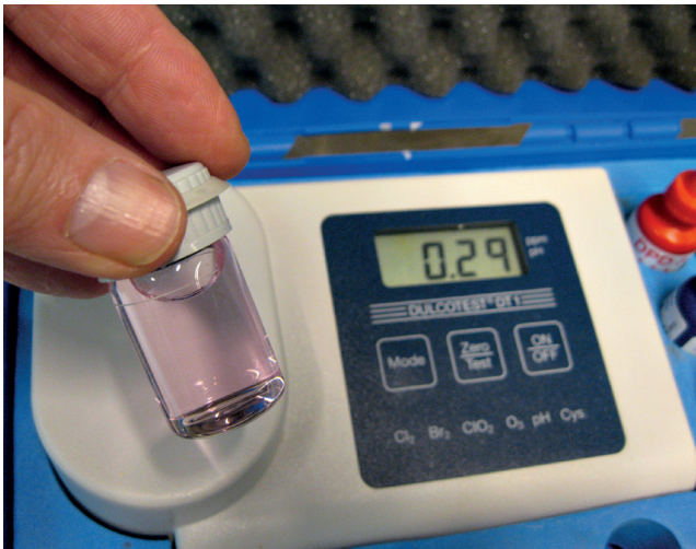
Abb. 9: Einfache fotometrische Messung des Chlorgehaltes nach der DPD-Methode (Foto Wohanka)
