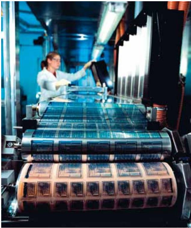
Abb. 11: Herstellung von polymeren Elektronikschaltungen über Druckverfahren (Foto: PolyIC GmbH & Co. KG)
