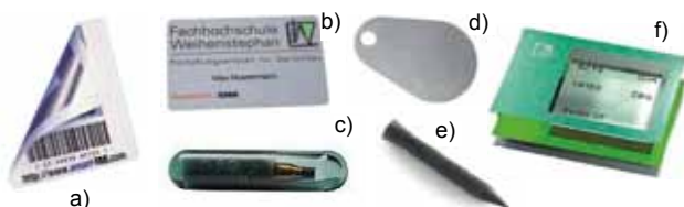
Abb. 2: Bauformen von RFID-Tags a) Klebeetikett, b) Karten-, c) Glas-, d) Anhänger-, e) Nagel-, f) DRFID-Transponder (Fotos: a) smart-TEC, b) Ohmayer, c) + e) TAGnology RFID GmbH, d) GiS, f) asec)
