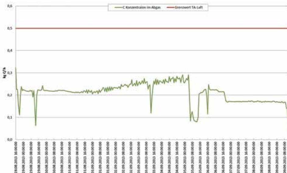
Abb. 4: Massenstrom des organisch gebundenen Kohlenstoffs im Off-Gas-Strom einer Aminwäsche als Funktion der Zeit; Grenzwert der TA-Luft (BMU 2002) für organische Stoffe (Angabe als Gesamtkohlenstoff) (Quelle: PTB)
