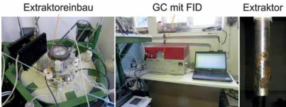
Abb. 6: Fotografien des in die Biogas-Laboranlage integrierten Messsystems sowie des Edelstahl-extraktors nach Beendigung der Messkampagne (Quelle: KSI-Meinzberg)
