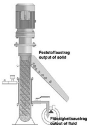
Abb. 1: Separationstechnik zur kontinuierlichen Feinfiltration
