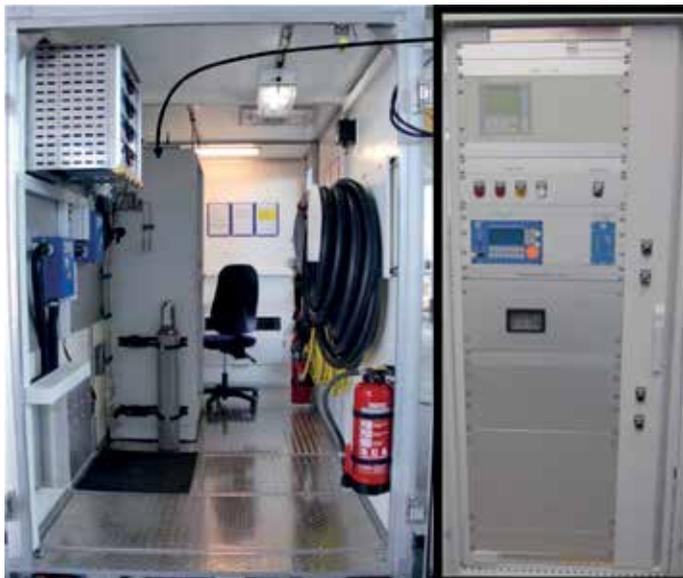
Abb. 3: Innenansicht des Pkw-Messanhängers mit Schaltschrank (Quelle: PTB)
