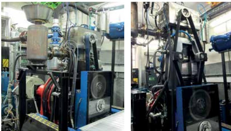
Abb. 2: LVK-Einzylinder-Forschungsgasmotor und Prüfstand, rechts: Aufbau optischer Brennraumzugang (Quelle: LVK)
