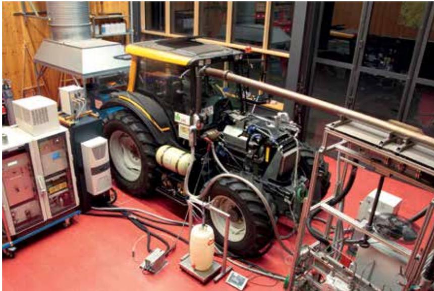
Abb. 1: Aufbau des Versuchsschleppers am Traktorenprüfstand
