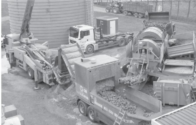
Abb. 11: Technikette mit Rübenwäsche, Willibald-Schredder und Betonpumpe im Einsatz zur Füllung eines Edelstahlsilos (Foto: KWS)
