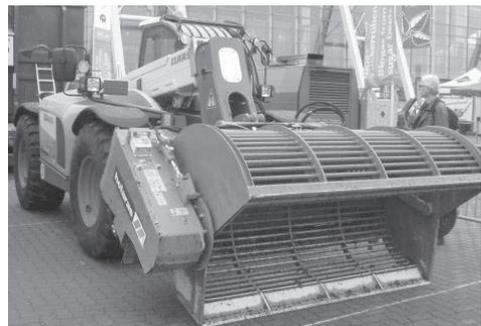
Abb. 8: Rübenwasch- und -schneidschaufel von Holaras (ohne Steintrennung) (Foto: KWS)
