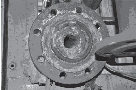
Abb. 4: Überwiegend carbonatische Ablagerungen im Rohrbereich
