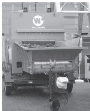
Abb. 9: Willibald-Schredder mit hoher Durchsatzleistung und „Steintoleranz“ (Foto: KWS)
