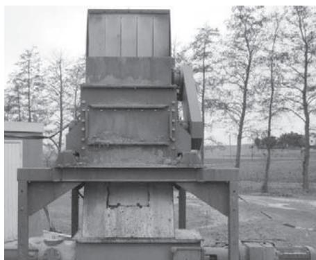
Abb. 10: Zerreißer von Putsch mit hohem Durchsatz und direkt angeschlossener Pumpe, allerdings steineempfindlich (Foto: KWS)
