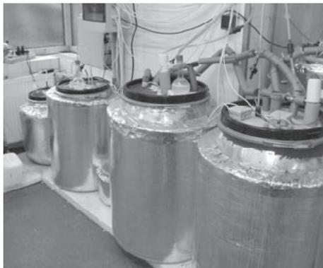
Abb. 5: 120 l-künstlicher Pansen, gekoppelt mit einer Methanstufe
