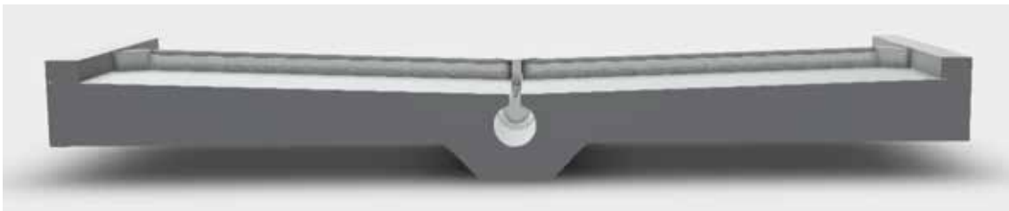
Abb. 17: Planbefestigter Boden mit Quergefälle und Harnsammelrinne (© KTBL)
