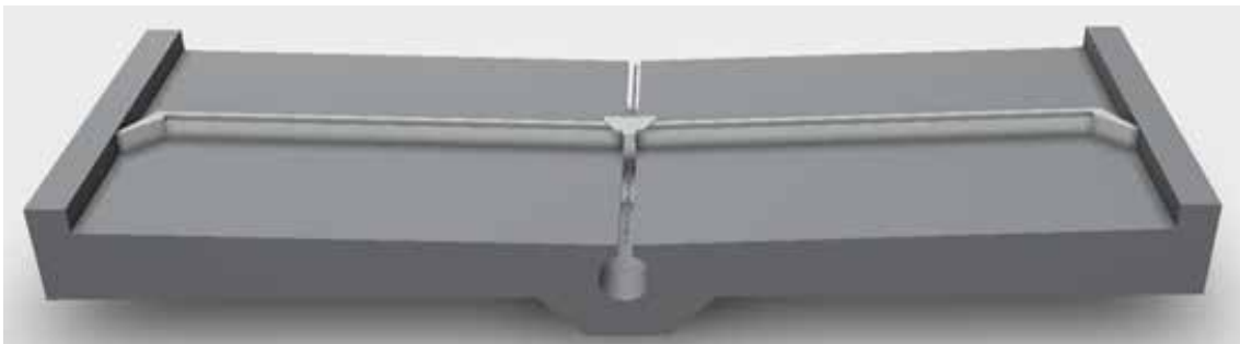
Abb. 18: Planbefestigter Boden mit Quergefälle, Harnrinne und angepasstem Entmistungsschieber (© KTBL)
