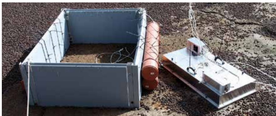
Messungen der Emissionen in einem Güllebehälter mit mineralischer Schwimmdecke
