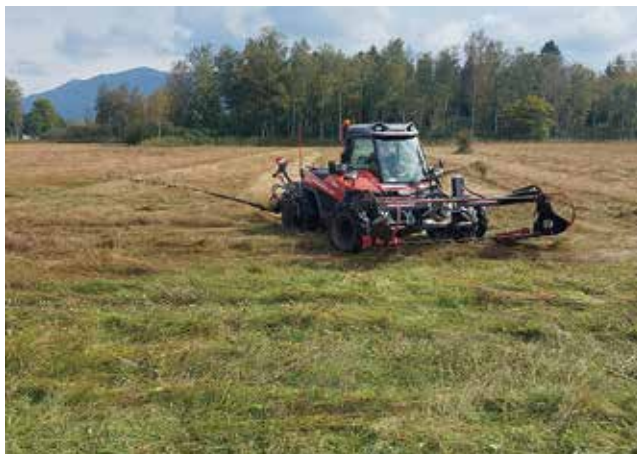
Fauna- und bodenschonende Mahd einer Wiese im Alpenvorland mit einem leichten Bergtraktor und Doppelmesser-Front-Heck-Schmetterlings-Kombination
