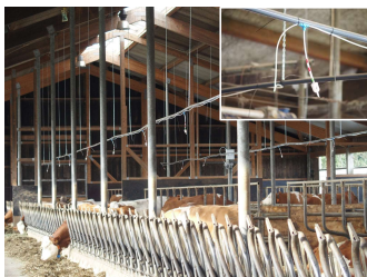
Messleitung mit Entnahmepunkten über kritische Kapillaren im Milchviehstall (© B. Eurich-Menden)
