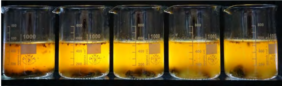
Abb. 1: Versuchsreihe im Jar Tester
