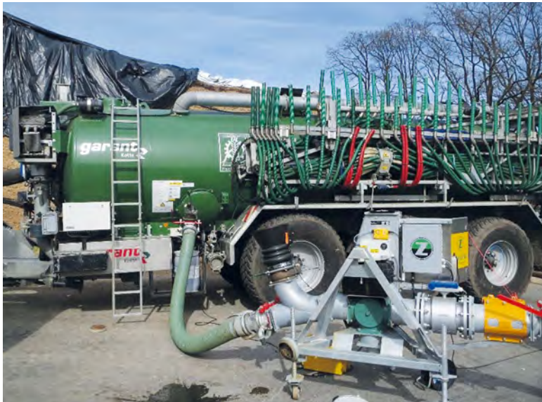
Abb. 5: Versuchsaufbau mit den NIRS-Messgeräten: John-Deere-Sensor verbaut am Güllefass und der Zunhammer-Station (© Baumkötter)
