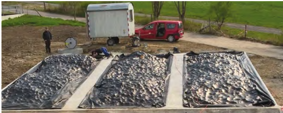
Abb. 4: Mit ganzen ungewaschenen Zuckerrüben gefüllte und verschlossene Hohenheimer Grubensilos nach der Vakuumierung (© Kumanowska)
