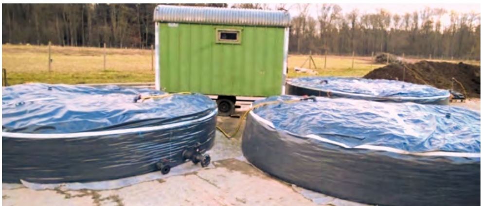
Abb. 3: Die mit gehäckselten Zuckerrüben gefüllten flexiblen Tanks nach dem Absaugen der Restluft (© Kumanowska)
