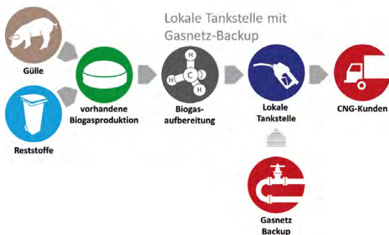
Abb. 4: Konzept der Installation einer lokalen Tankstelle mit Gasnetz-Backup (eigene Darstellung IBKE)
