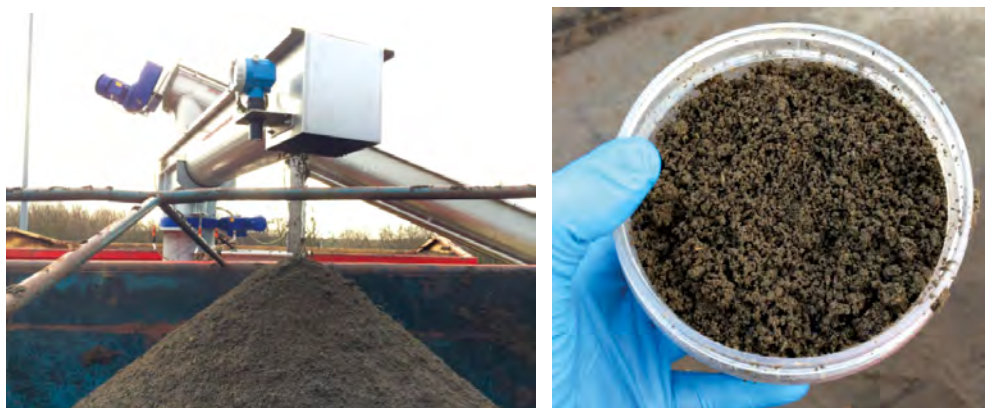
Abb. 3: Entwässerter Gärrest mittels Dekanterzentrifuge (© Vith/Böhlert)
