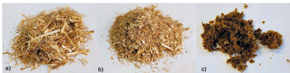
Abb. 3: a) unbehandeltes Winterweizenstroh (gehäckselt); b) mechanisch desintegriertes Winterweizenstroh (trocken extrudiert/gemahlen) c) mechanisch-chemisch desintegriertes Winterweizenstroh (trocken extrudiert + Einweichen in Natronlauge) (© Andrade)
