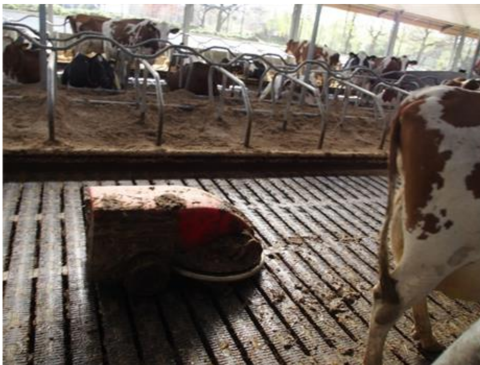
Abb. 2: Emissionsarmer Spaltenboden mit Reinigungsroboter, Bild: Eurich-Menden
