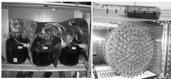
Abb. 1: Apparaturen unterschiedlicher Größe zur Durchführung von Batch-Gärtests. (Fotos: links: gewitra mbH, rechts: Landesanstalt für Agrartechnik und Bioenergie, Universität Hohenheim)
