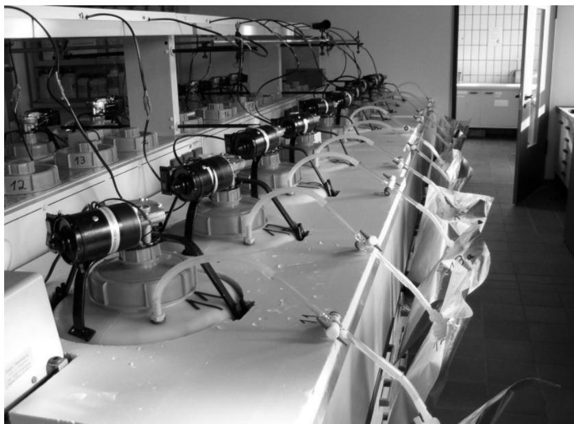
**Abb. 2:** Versuchsanlage zur Biogasertragsmessung (Bild Walter Zerr, Eichhof)
