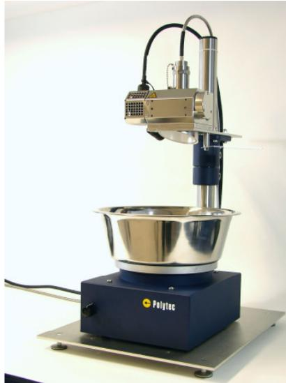
**Abb. 7:** Atline NIRS- Messstand Serienmodell PSS-A-T01 Fa. Polytec GmbH
