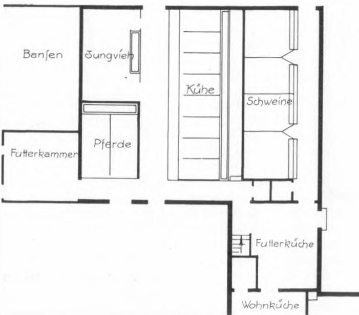
Abb. 27. Stallgrundriß mit Queraufstallung beim Winkeltyp.
