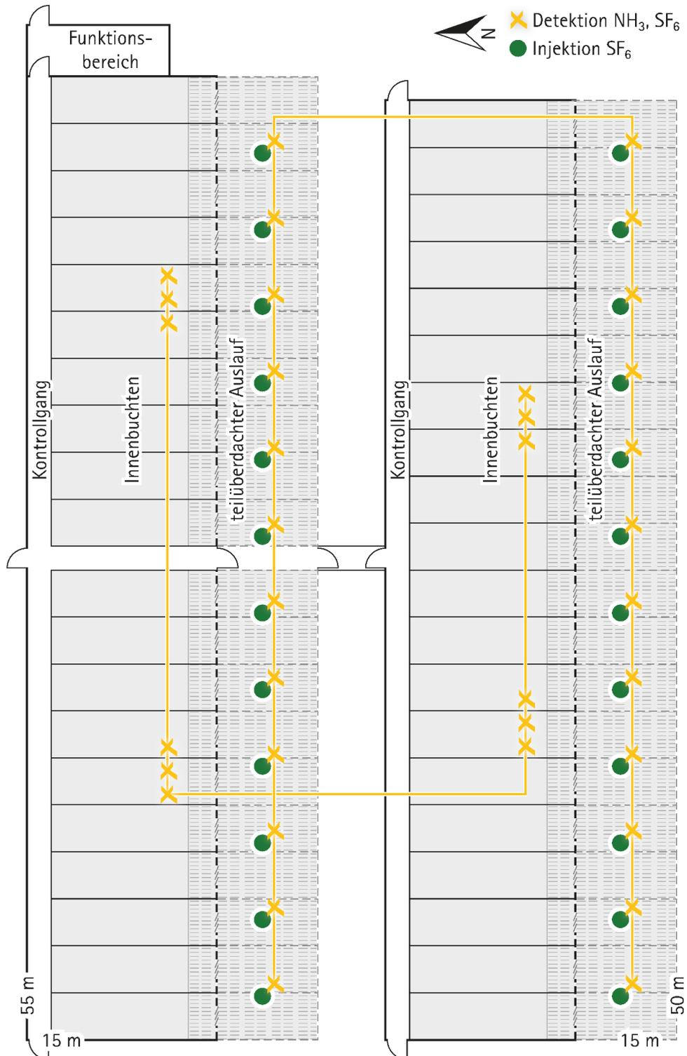
Abbildung 6: Stallansicht und Auslauf Spalte 2 mit schematischer Einzeichnung der Injektionsdüsen für SF<sub>6</sub> (grüne Punkte) und der Detektionslinie und der Probennahmepunkte (gelb) für SF<sub>6</sub>, NH<sub>3</sub> und CH<sub>4</sub> (© KTBI )
