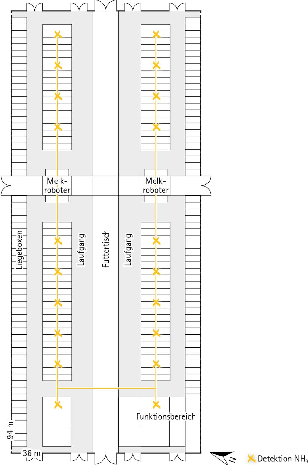
Abbildung 7: Stallansicht Plan 4 mit schematischer Einzeichnung der Detektionslinie und der Probenahmeplätze (gelb) für NH<sub>3</sub>, CH<sub>4</sub> und CO<sub>2</sub> (© KTBL)
