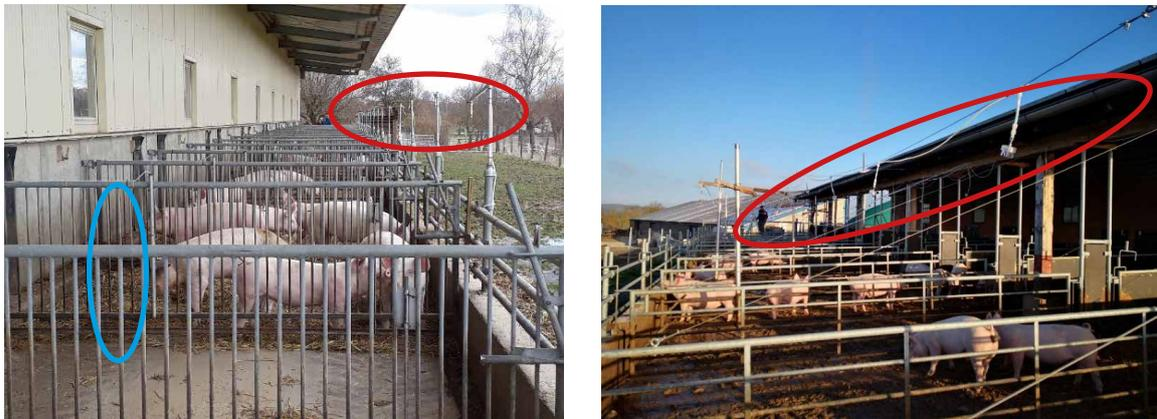
Abbildung 18: Messaufbauten an den Standorten der Bauvarianten „Plan 4“ (links) und „Plan 1“ (rechts) mit Zudosierungsleitung für  $\text{SF}_6$  (im blauen Kreis) und Gasprobennahmeleitung (roter Kreis); die Gasprobennahmeleitung ist bei „Plan 4“ schwenkbar. (© KTBL)
