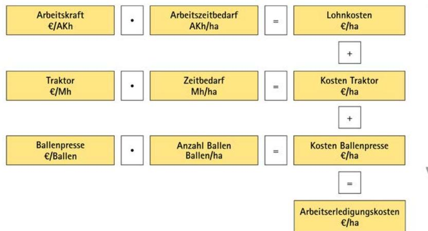
Abb. 4: Kalkulation der Arbeitserledigungskosten eines Arbeitsverfahrens am Beispiel „Ballen pressen“
