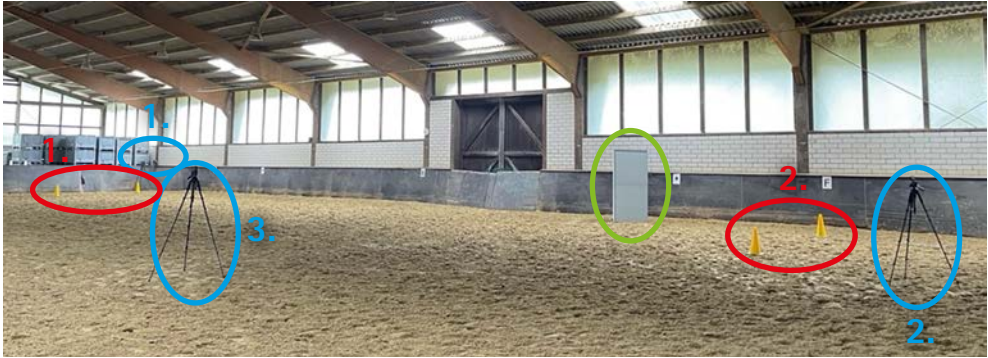
Abb. 1: Versuchsaufbau mit mobiler Trennwand (grüne Markierung), Startpunkt (1. rote Markierung), Endpunkt (2. rote Markierung), Kamera 1 (1. blaue Markierung), Kamera 2 (2. blaue Markierung), Kamera 3 (3. blaue Markierung) (© M. Schiefer)
