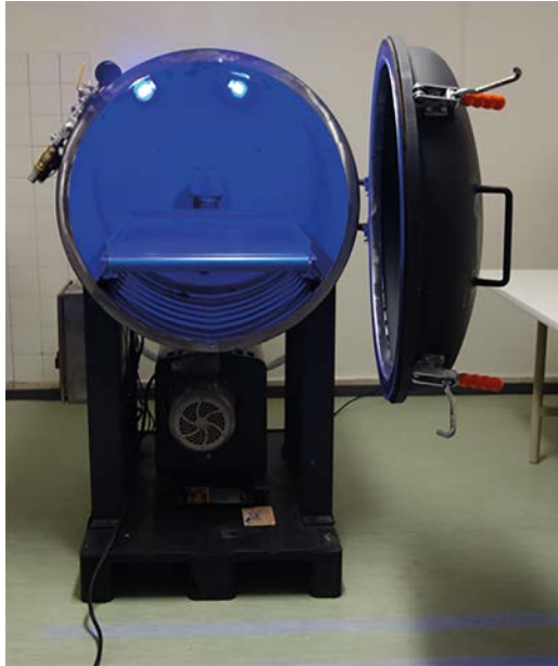
Abb. 1: Der LAPS-Prototyp im Versuchsraum. Zu sehen ist die geöffnete Betäubungskammer, die durch blaues Licht ausgeleuchtet wird. (© F. Kuck)
