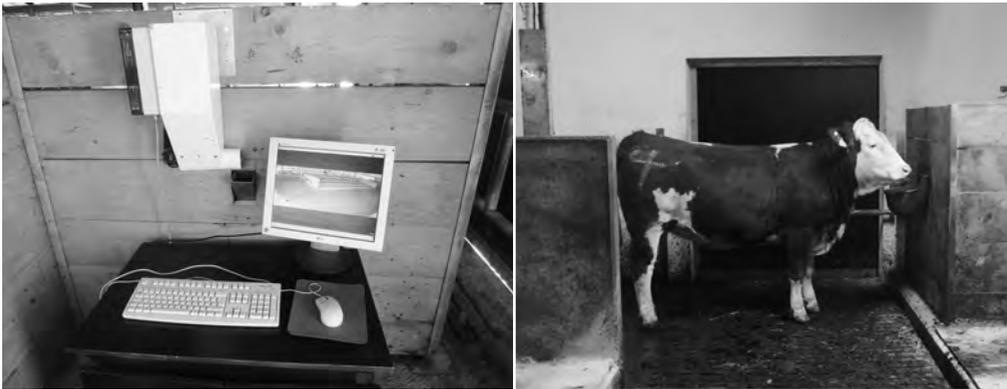
Abb. 1: Lernapparat mit akustischem Aufruf bestehend aus einem fernbedienten Dosierer, einem PC mit Lautsprechern und einem Futtertrog (Fotos: J. Woodrow)
