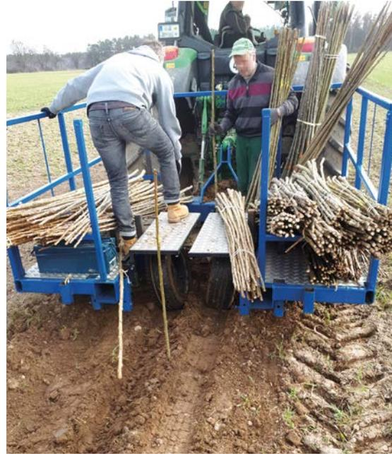
Abb. 4: Die Ruten werden während der Fahrt in die Furche gesetzt und mit schräglaufenden Reifen ange-
