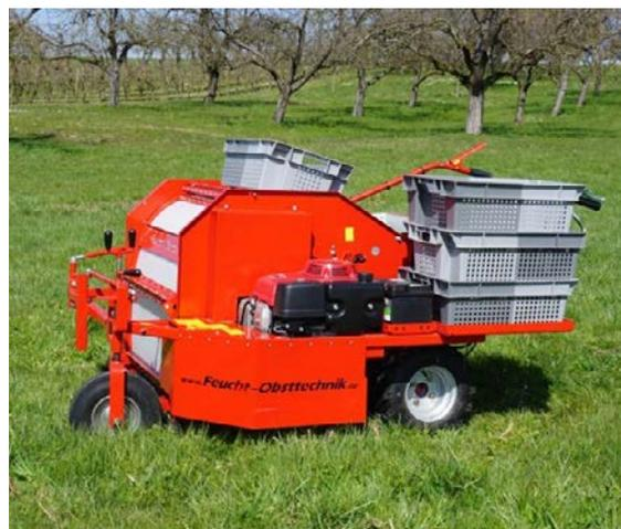
Abb. 8: Handgeführte Auflesemaschinen: Obstwiesel OW85 von Bäuerle (links, © Bäuerle Landtechnik) und Obstaufsammelmaschine OB 80 hydro von Feucht (rechts, © Feucht Obsttechnik)
