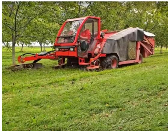
Abb. 13: Nusserntemaschine X16 von AMB ROUSSET (© AMB Rousset)
