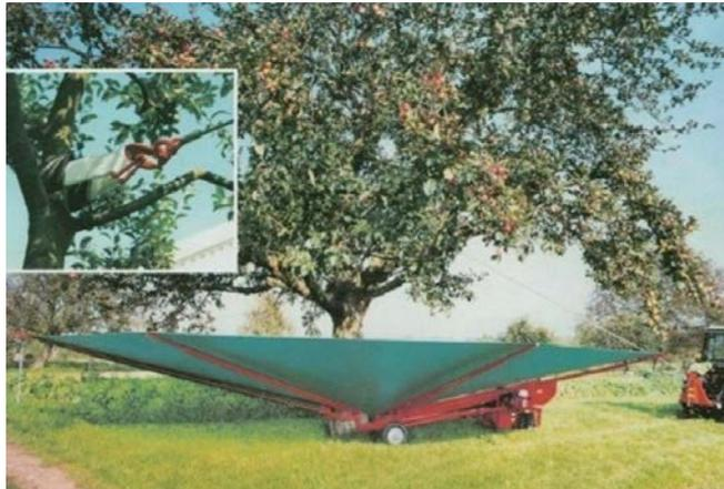
Abb. 11: Kirschernte mit Seilschüttler und Auffangschirm (© Harter Landtechnik)
