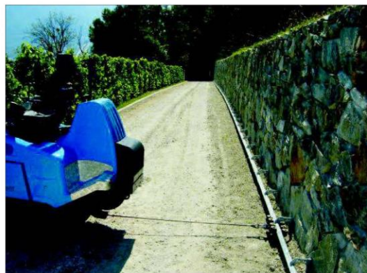
Lösung auf Basis einer Schiene, die den Pritschenanhänger überflüssig machen sollte. Das System hat sich nicht durchgesetzt. Foto: DLR Mosel
