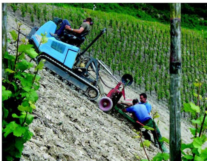
Möglichkeiten des Einsatzes einer Pflanzmaschine im Steilhang dank RMS-Technik. Foto: DLR Mosel
