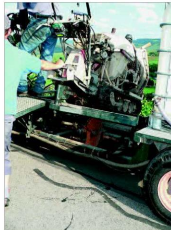
Pritschenanhänger mit Standardseilwinde der Fa. Binger Seilzug. Foto: DLR Mosel
