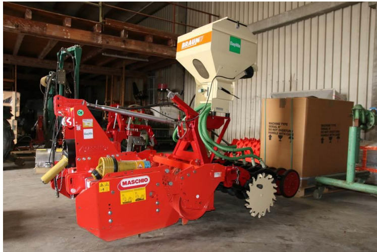
Abb. 2: Gerätekombination aus Kreiselegge und Sämaschine der Fa. Horsch
