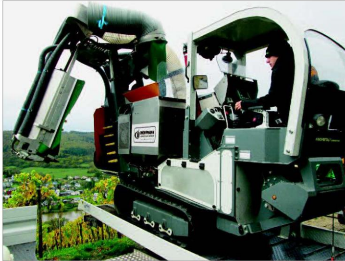
Der Steillagenvollernter der Fa. Hoffmann aus Piesport ist praxisreif.
