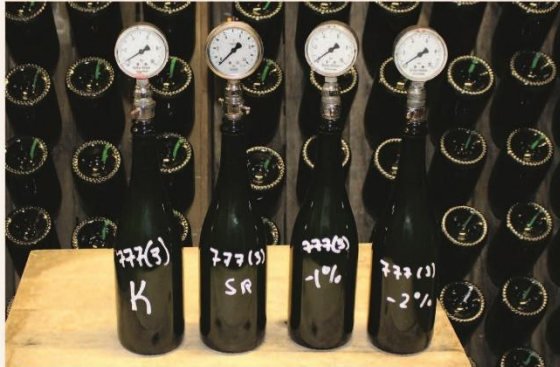
Die Versuchsvarianten wurden zur Bestimmung des Drucks mit Manometern verschlossen
