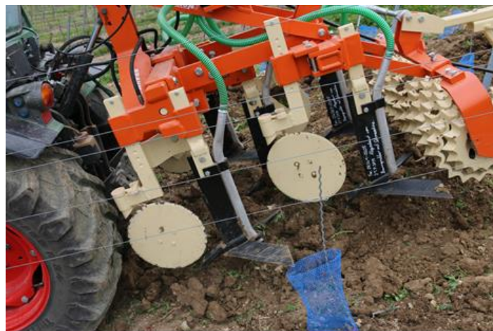
Abb. 1: Schichtengrubber der Fa. Braun mit modifizierten Scharstielen zur Saatgutablage
