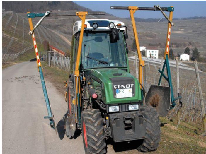
Abb. 9: Scheibenpflug der Fa. Rust im Zwischenachsenbau mit Prallblechen (© Ernst Weinmann)
