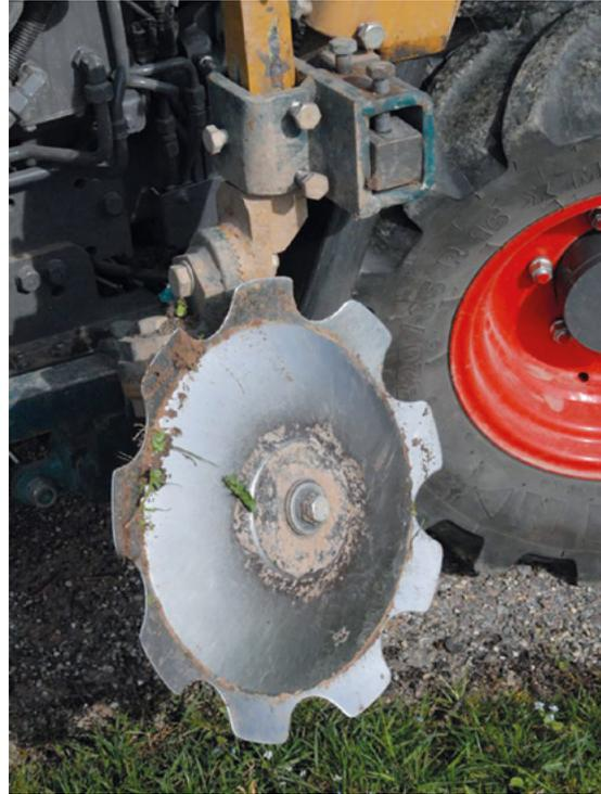
Abb. 8: Innenscheibe zur Verringerung des Bodentransports in die Nachbarzeile
