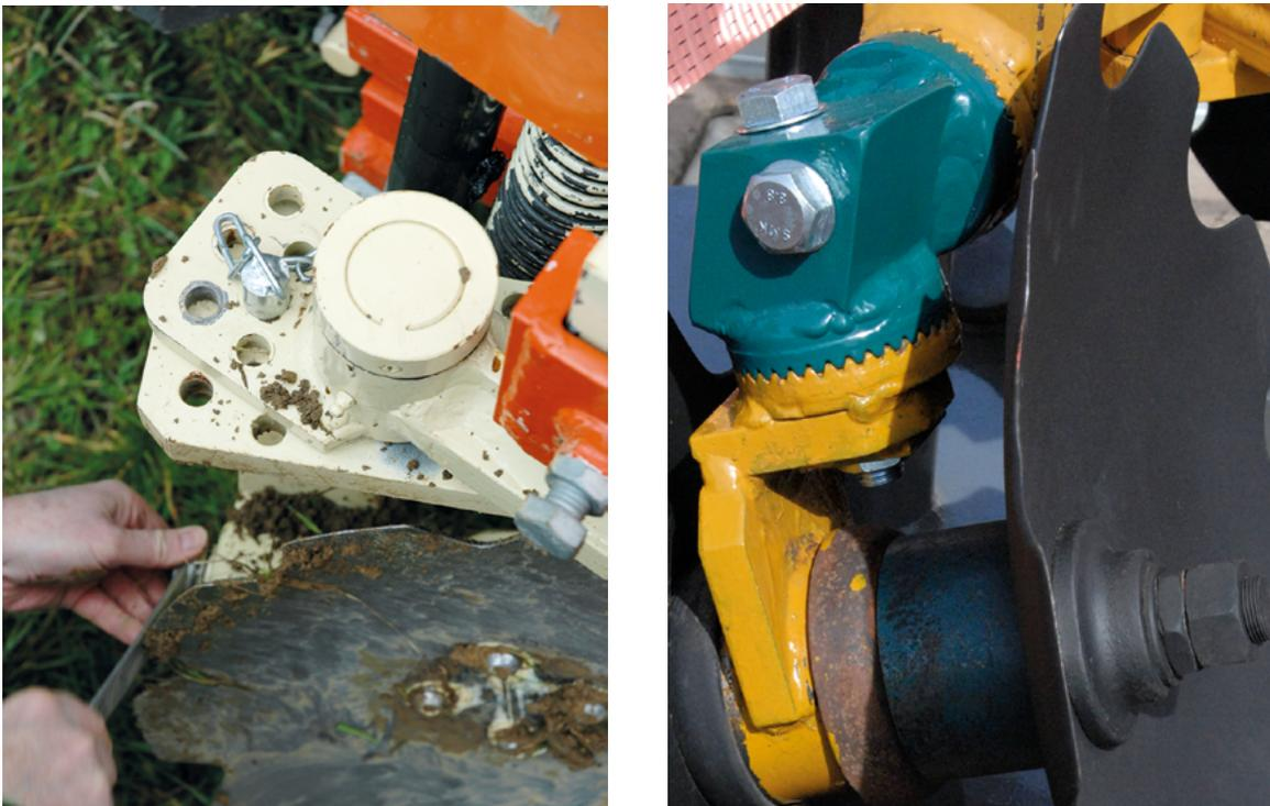
Abb. 3: Einstellung des Scheibenpfluges über Lochplatten (links) bzw. Zahnscheiben (rechts) (© Ernst Weinmann)
