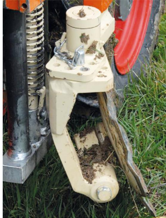
Abb. 6: Kapsel mit innenliegendem verzahntem Gelenk
