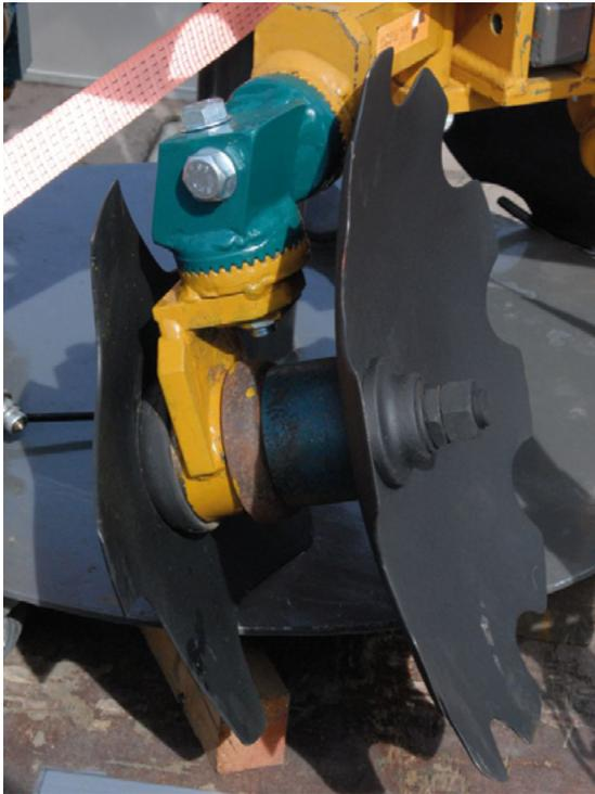
Abb. 7: Doppelscheibe zur Minimierung der Pflugrinne
