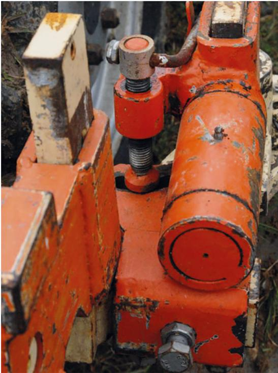
Abb. 5: Obenliegende Einstellungsspindel der Fa. Braun
