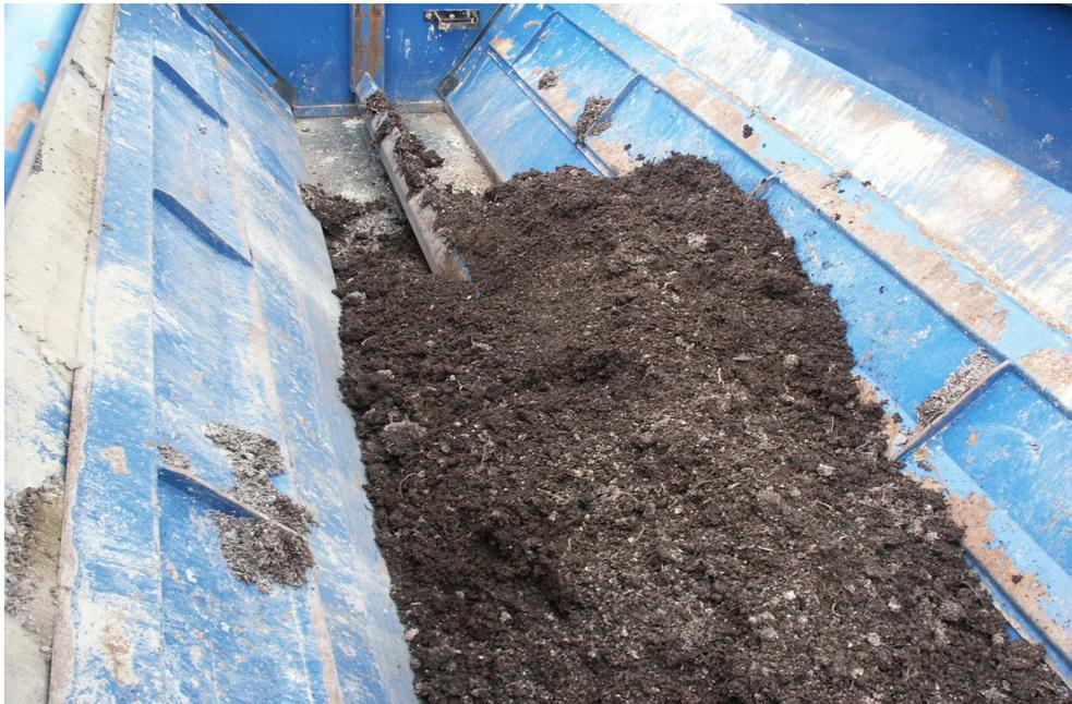
Abb. 4: Innenansicht des Materialcontainers mit 10m<sup>3</sup> Ladevolumen mit Zufuhrförderband zum Gebläselaufrad
