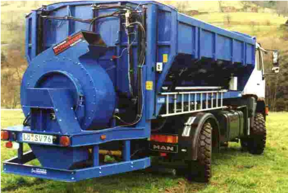
Abb. 3: LKW 10m<sup>3</sup> Ladevolumen mit Allradlenkung und EU-patentiertes Schneider Gebläse
