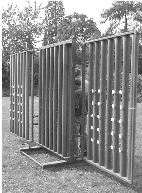
Abb. 22: Penetrationsmessstand geöffnet während der Probenahme
