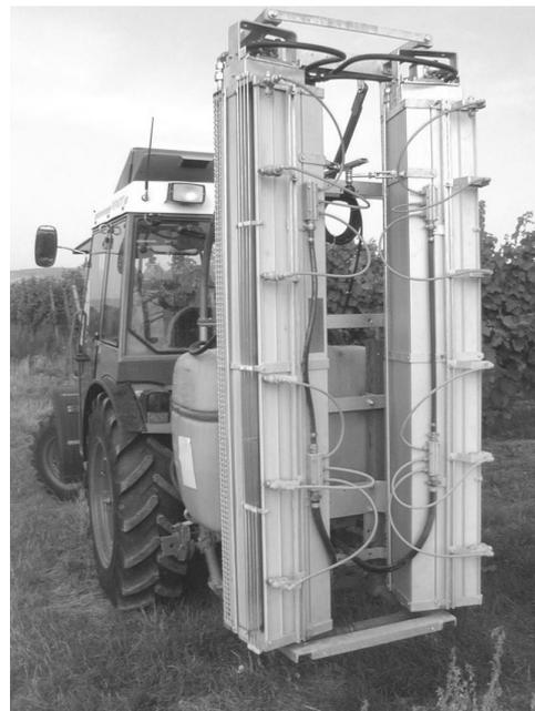
Abb. 11 und 12: Tangentialgebläse in der bisherigen und einer überarbeiteten Ausführung mit außenliegenden Düsenstationen
