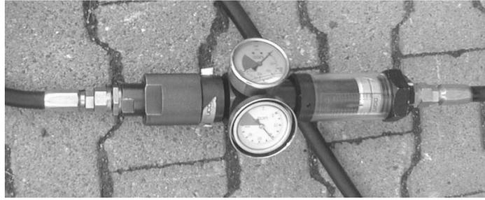
Abb. 15: Druck- und Durchflußmesser zur Ermittlung der Hydraulikleistung
