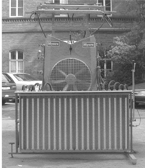
Abb. 13: Einzeldüsenprüfstand zur Gerätekalibrierung
