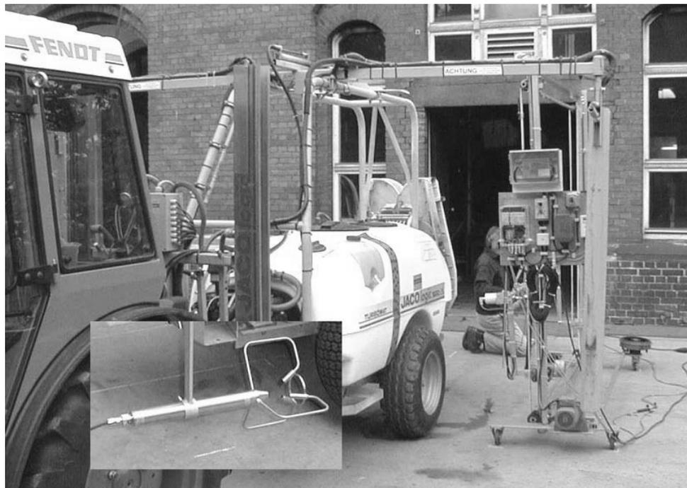
Abb. 16: Messstand zur Erfassung der Luftstromprofile (Einblendung: Ultraschall-Sensor für Luftgeschwindigkeit und Strömungsrichtung)
