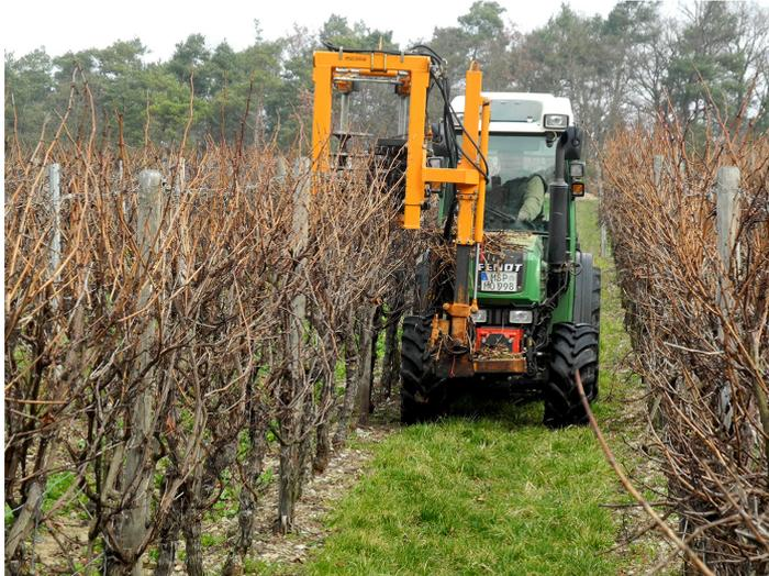
Abb. 3: Kronenrückschnitt mit dem Vorschneider (Foto: Schwab)
