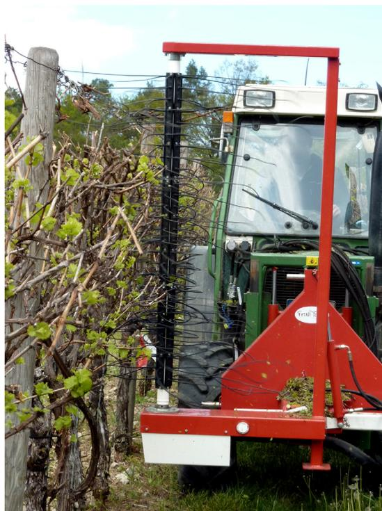
Abb. 2: DARWIN-Rotor der Firma Fruit-Tec im Einsatz kurz nach dem Austrieb in Anlage mit erfolgtem Kronenrückschnitt im Winter (Foto: Schwab)
