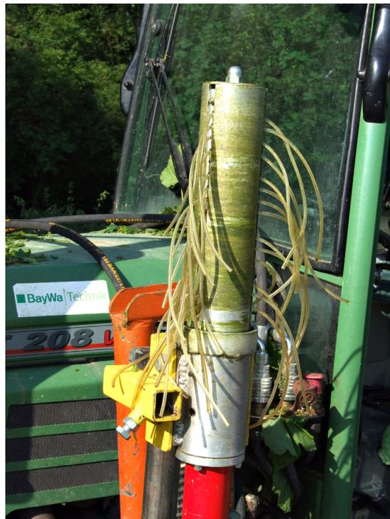
Abb. 1: KMS-Rinklinbürste mit weichen Schnüren zur Ertragsreduzierung nach der Blüte bis Stecknadelkopfgröße der Beeren (Foto: Schwab)
