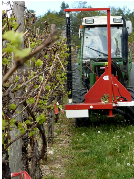
Abb. 4: Triebreduzierung mit dem DARWIN-Rotor nach dem Austrieb (Foto: Schwab)
