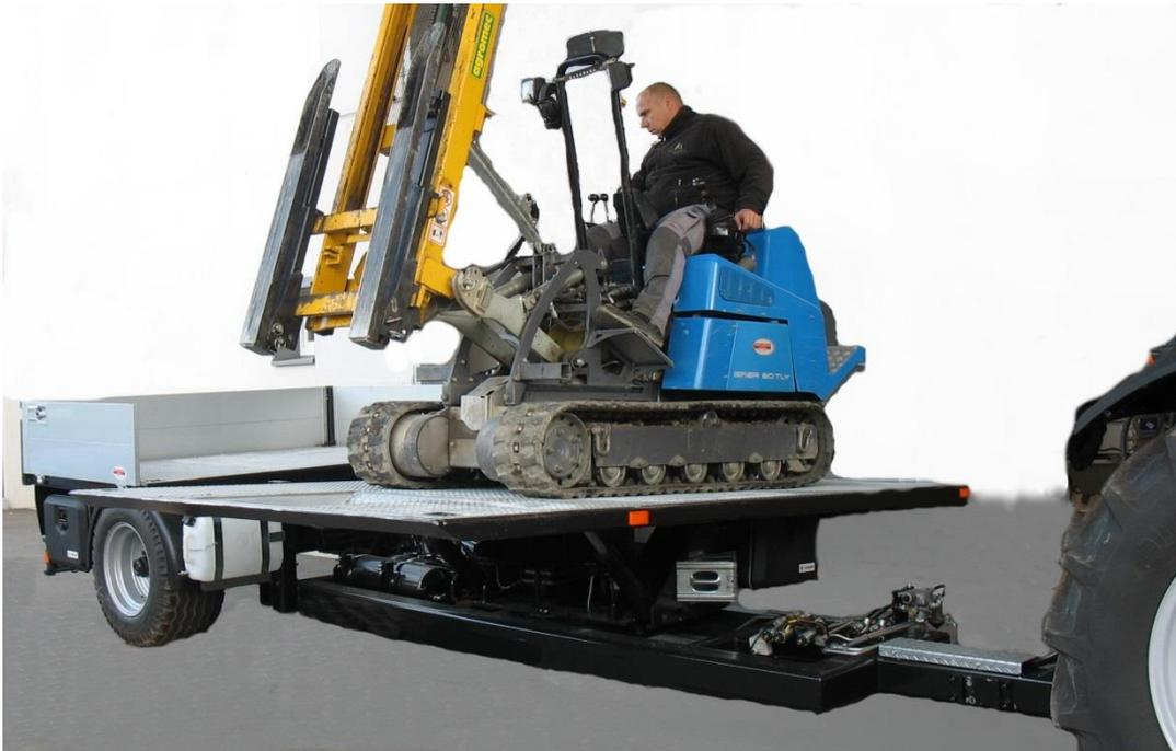
Abb. 48: RMS-Trägerfahrzeug der Firma Piesporter Landmaschinen mit Drehpritsche auf Höhe der Transportplattform.
