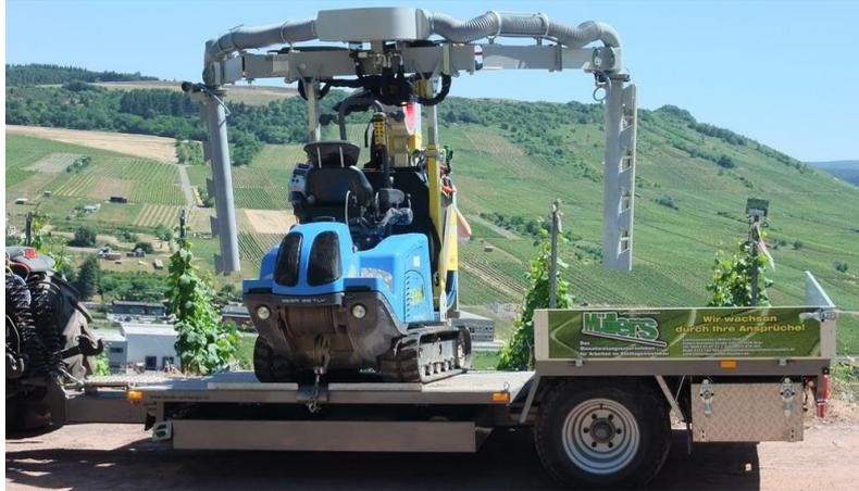
Abb. 36: Einachs-RMS-Trägerfahrzeug mit Kipppritsche vorn und Transportpritsche hinten
