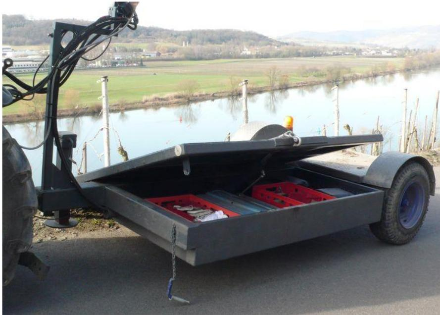
Abb. 40: Eigenbau 2 – RMS-Trägerfahrzeug in besonders leichter und kompakter Bauweise ohne Transportspritsche. Der Seilanschlag befindet sich seitlich an der Kipppritsche.
