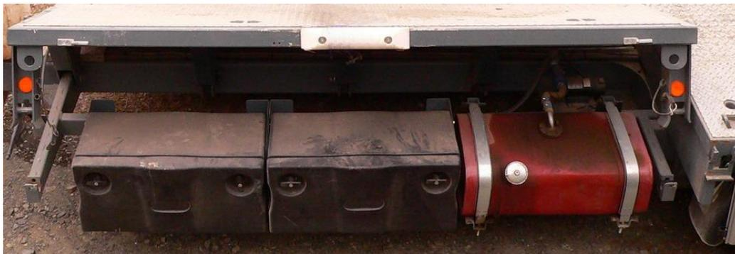
Abb. 30: RMS-Trägerfahrzeug mit Staufächern für Werkzeug und Dieseltankanlage zum Betanken der RMS-Raupe unter der Kipppritsche.
