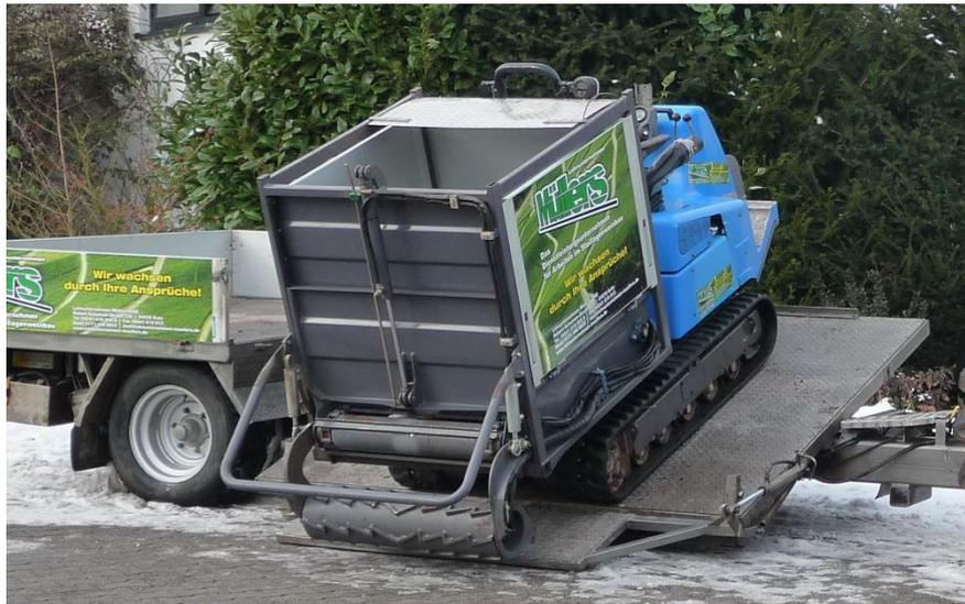
Abb. 42: Bender RMS-Trägerfahrzeug tiefer Kipppritsche. Der Seilanschlag befindet sich an der Kipppritschenkante.
