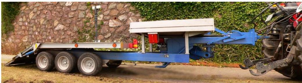
Abb. 37: RMS-Trägerfahrzeug mit Tridemachse und Transportpritsche vorn
