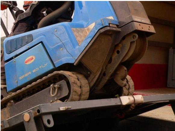
Abb. 52: RMS-Trägerfahrzeug mit Anschlagpunkt unter der Kipppritsche für Raupen mit tiefem Seileinlauf.
