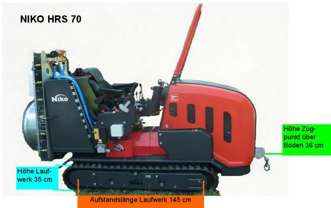
Abb. 28: Seitenansicht der NIKO HRS 70 mit 200 l Aufbausprühgerät. Die Gewichtsverteilung ist ähnlich der der NIKO HRS 90 und lag bei unseren Messungen mit leerem Sprühgerät bei 59% vorn und 41% hinten, bei vollem Behälter bei 51% vorn und 49% hinten und somit ausgeglichen. Bedingt durch die kurze Bauweise verfügt die NIKO HRS 70 nur über einen kurzen Anbauraum für Aufbaugeräte und Dreipunkthebevorrichtung.
