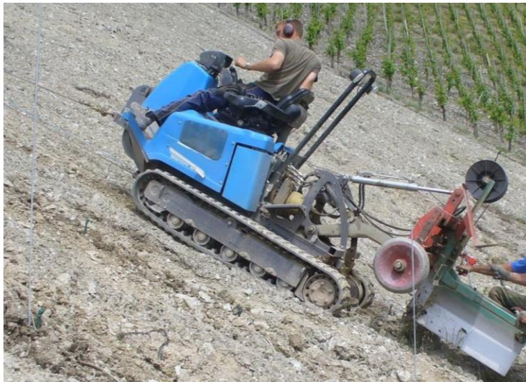
Abb. 9: Bei der Talfahrt mit ausgehobener Easy-Plant-Pflanzmaschine wird das Gewicht auf den hinteren Laufwerksbereich verlagert.
