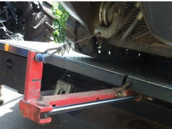
Abb. 54: RMS-Trägerfahrzeug mit hydraulisch ausfahrbarem Seilanschlagpunkt
