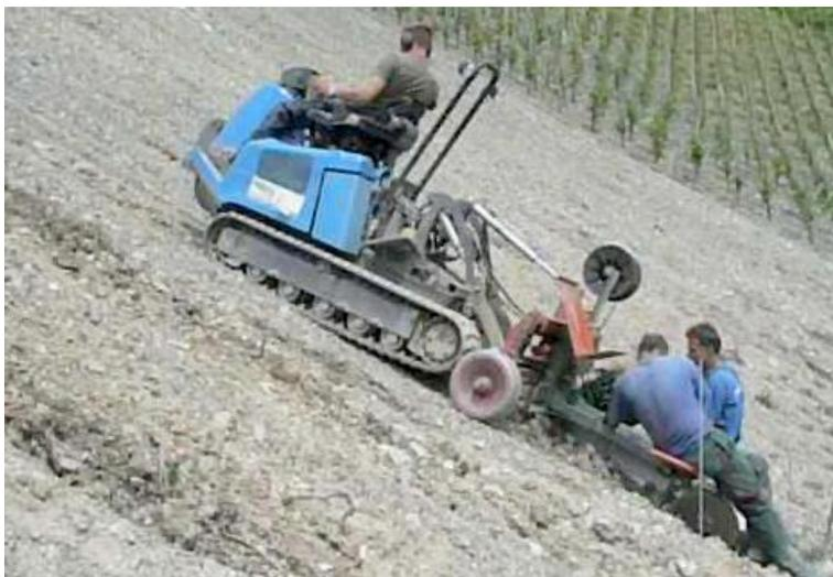
Abb. 10: Beim Auftreten einer großen Zugkraft an einem hohen Zugpunkt, wie hier durch die Zugunterstützung durch einen Schlepper mit Forstwinde kommt es zu einer Gewichtsverlagerung auf den vorderen Laufwerksbereich.
