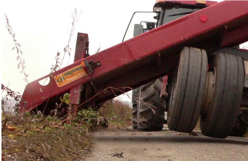
Abb. 8: Die Abstützung des Hoffmann RMS-Trägerfahrzeugs erfolgte durch eine Stahlplatte an der Kante der Drehpritsche und zwei zusätzliche hydraulische Sporne
