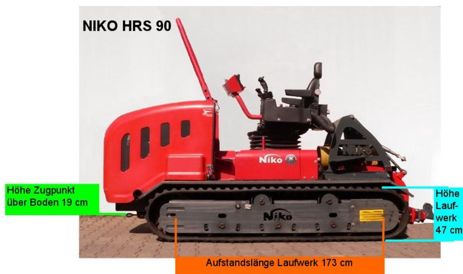
Abb. 26: Seitenansicht der NIKO HRS90 mit Dreipunkthebewerk. Bedingt durch die zentrale Anordnung der Winde und dem kurzen Überbau der Motorhaube über das Bandlaufwerk, zeigt diese Raupe mit Hebewerk ohne Geräte eine relativ ausgeglichene Gewichtsverteilung von 61% vorn und 39% hinten.
