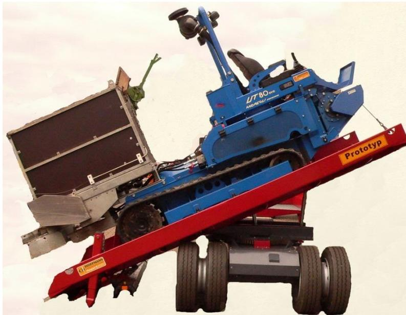
Abb. 43: Hoffmann RMS-Trägerfahrzeug mit Drehkippritsche und zwei hydraulischen Spornen zur Abstützung. Der Seilanschlag befindet sich auf der Oberseite der Kipppritsche.
