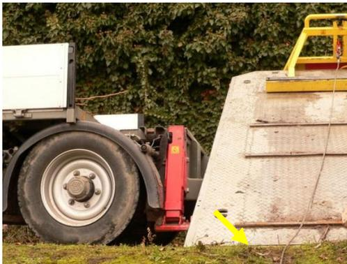
Abb. 34: Das KMS-Rinklin Trägerfahrzeug mit Drehkippritsche stützt sich über die Drehkippritsche ab und verfügt zusätzlich über beidseitige hydraulische Stützen zwischen Kipppritsche und Achse
