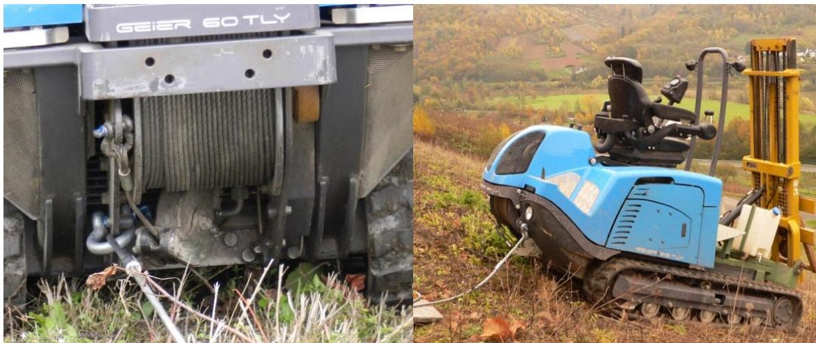
Abb. 6: Die Messung der Standfestigkeit der unterschiedlichen RMS-Trägerfahrzeuge erfolgte bei Verwendung von Geier-Raupen 60TLY (links) und 85TLY (rechts) durch Seilbefestigung am Rahmen der Raupe.
