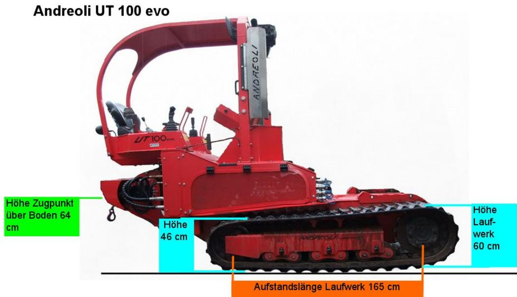
Abb. 23: Seitenansicht der Andreoli UT100evo ohne Dreipunkthebewerk. Deutlich erkennbar ist die Frontlastigkeit, die ohne An- Aufbaugeräte das hintere Laufwerk vom Boden abhebt. Hierdurch ist diese RMS Raupe hervorragend für den Einsatz von schweren Arbeitsgeräten geeignet
