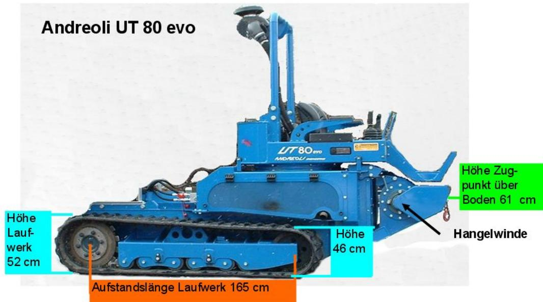
Abb. 20: Seitenansicht der Andreoli UT80evo. Durch die frontseitig weit herausragende Hangelwinde weist diese Raupe mit Hebwerk ohne Anbaugeräte eine Gewichtsverteilung 88% vorn und 12 % hinten auf.
