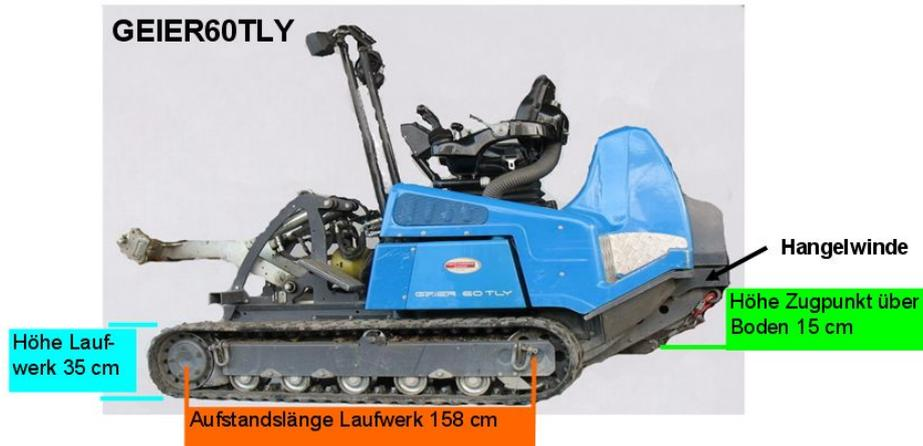
Abb. 13: Seitenansicht der Geier 60TLY. Die frontseitig vor dem Bandlaufwerk angebaute Hangelwinde führt in der Ausstattung mit Hebewerk ohne Anbaugeräte zu der Gewichtsverteilung von 74 % vorn und 26 % hinten
