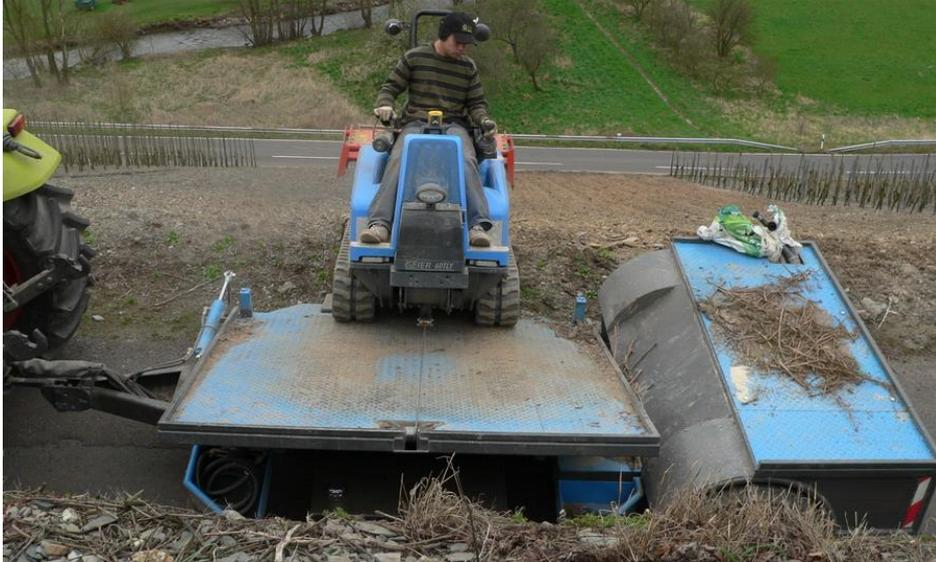
Abb. 39: Eigenbau 1 – RMS-Trägerfahrzeug in kompakter Bauweise mit Transportplateau für Betriebsmittel hinter der Fahrzeugachse. Der Seilanschlag befindet sich unterhalb der Kipppritsche.
