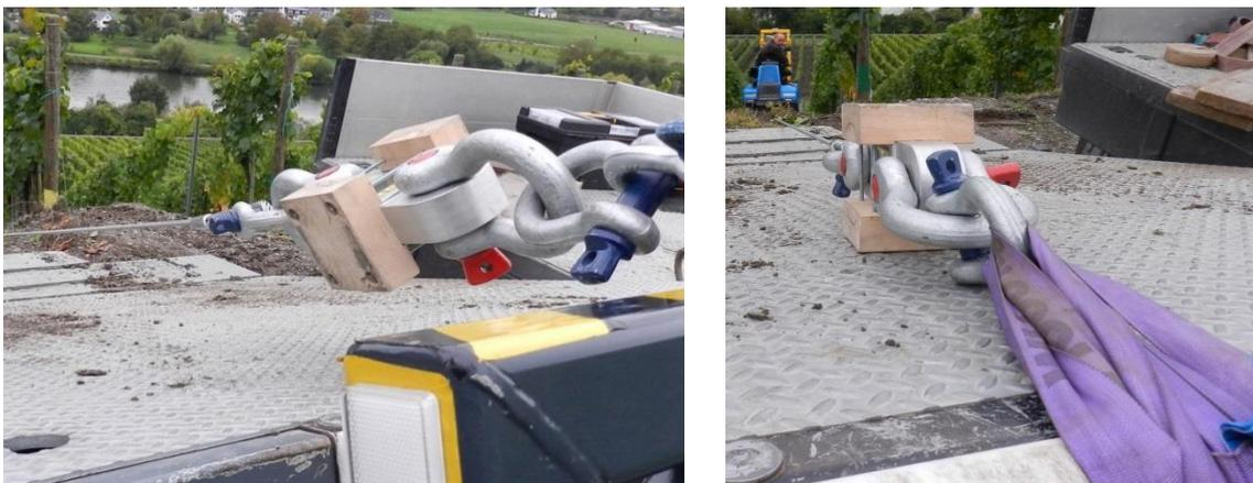
Abb. 4: Durchführung der Zugmessungen und Ermittlung der Differenz durch Querkräfte im freien Zug (links) und bei Auflage des Dynamometers auf der Kipppritsche (rechts)
