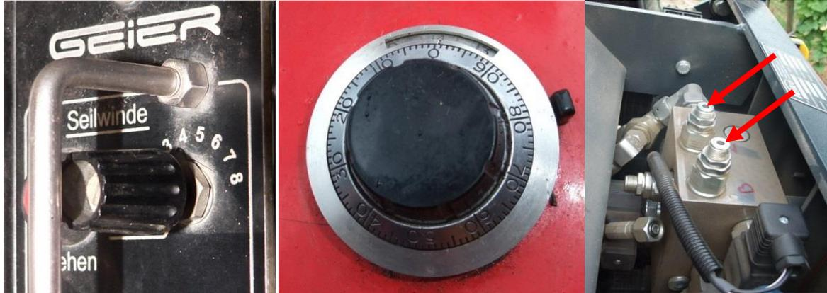
Abb. 12: Einstellung der Windenzugkraft über Potentiometer; links Geier, Mitte Andreoli (Niko HRS 90 ist ähnlich), rechts Niko HRS 70 bei geöffneter Motorhaube (Einstellmöglichkeit für Tal- und Bergfahrt über zwei getrennte Regelventile)
