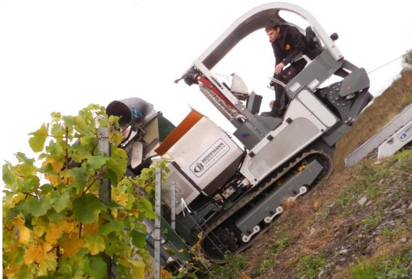
Abb. 11: Der hohe Zugpunkt der Andreoli-RMS-Hangelwinde erhöht die Belastung des vorderen Laufwerkbereichs und ermöglicht dadurch den Einsatz von sehr schweren An-/Aufbaugeräten.
