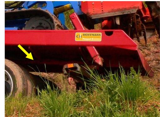
Abb. 35: Die Abstützung der Drehkippritsche beim Trägerfahrzeug der Firma Carl Hoffmann beruht auf einer breiten Kante am Ende der Pritsche, die am Wegrand in den Boden gedrückt wird und zwei hydraulischen Spornen
