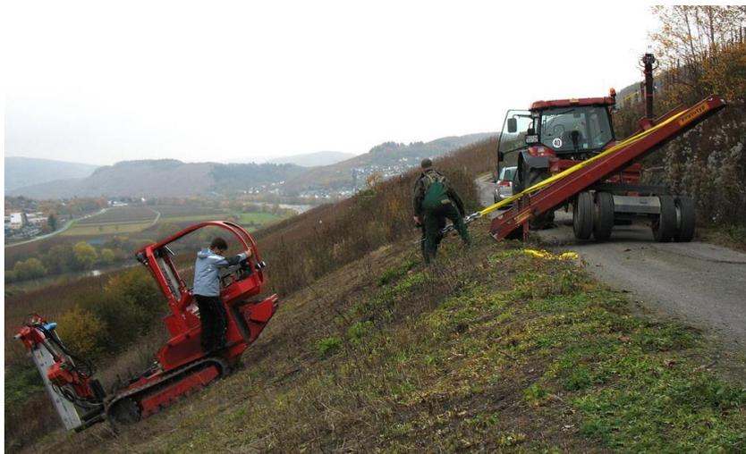
Abb. 7: Die Messung der Standfestigkeit des Hoffmann RMS-Trägerfahrzeugs erfolgte mit der Andreoli RMS-Raupe UT 100evo. Hierbei war nur ein Zug über die Winde möglich.
