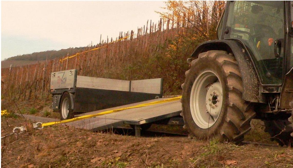
Abb. 47: RMS-Trägerfahrzeug der Firma Piesporter Landmaschinen mit tief liegender Kipppritsche.
