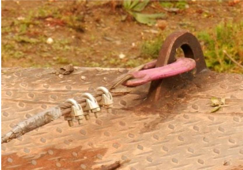
Abb. 60: Seilendverbindungen mit Drahtseilklemmen sind für den ordnungsgemäßen Einsatz von Raupenmechanisierungssystemen nicht zulässig
