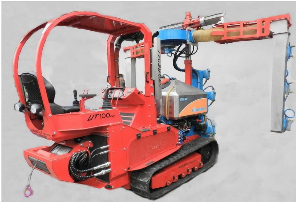
Abb. 24: Andreoli UT100evo mit Überzeilensprüngerät (2 Radialgebläse für 4 Teilbreiten) und 500l Brühbehälter
