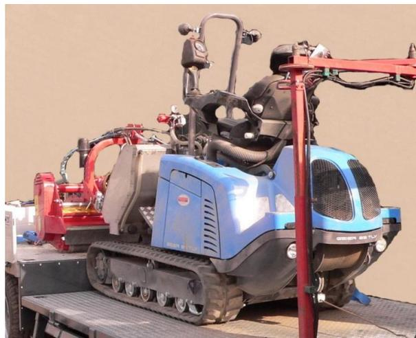
Abb. 38: Die Abstufung von der Transport- zur Kipppritsche dient als fester Anfahrpunkt in der Transportstellung
