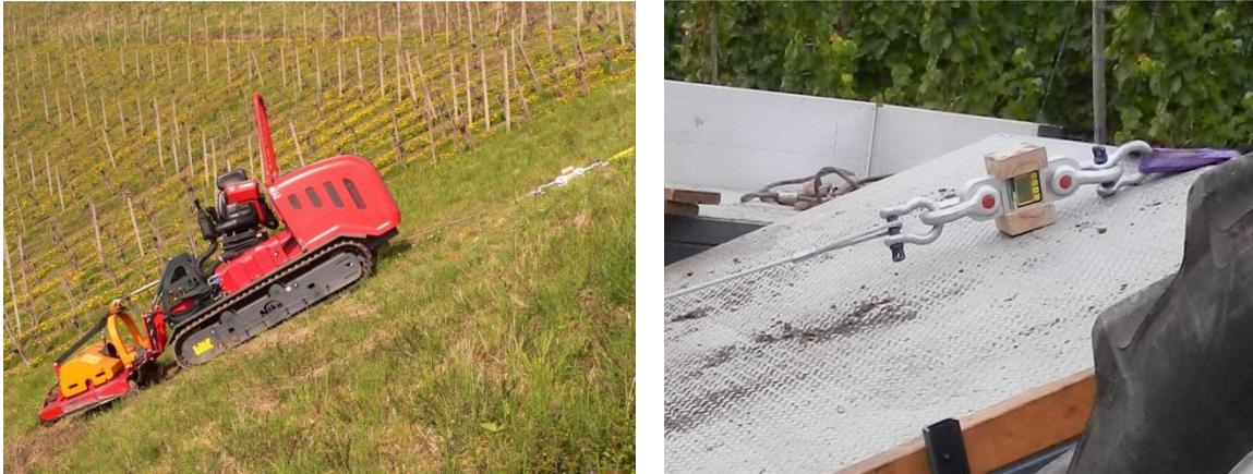
Abb. 3: Ermittlung der Zugkräfte der Hangelwinden verschiedener RMS bei unterschiedlicher Potentiometereinstellung; links Zugmessung mit frei hängendem Dynamometer; rechts bedingt durch den Seilanschlag unterhalb der Kipppritsche lag das Messgerät bei den Zugmessungen auf der Pritsche auf.
