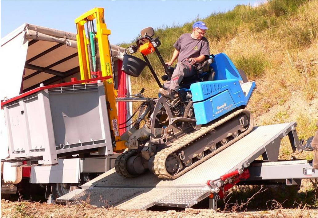
Abb. 41: KMS-Rinklin RMS-Trägerfahrzeug mit einseitiger Kipppritsche auf gleicher Höhe wie die Transportpritsche. Der Seilanschlag befindet sich unter der Kipppritsche
