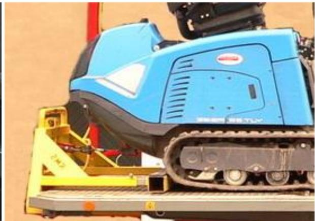
Abb. 53: RMS-Trägerfahrzeug mit Überfahrerschutz, einstellbarem Anfahrpunkt zur Bestimmung der Parkposition und in der Höhe variablen Seilanschlagpunkten
