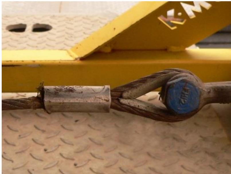
Abb. 59: Seilkausche mit Pressklemme
