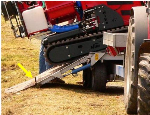
Abb. 32: Beim Durmatec RMS-Trägerfahrzeug wird die Drehklapppritsche zur Abstützung am Wegrand in den Boden gedrückt
