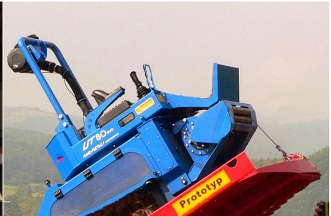
Abb. 51: RMS-Trägerfahrzeug mit Anschlagpunkt auf der Kipppritsche. Bei Raupen mit hohem Zugpunkt entsteht ein ungünstiger Zugwinkel
