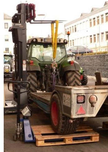
Abb. 5: Ermittlung der Anhängemasse und der Stützlast an der Zugöse mittels Handhubwaagen und Palettenwaage (links) bzw. Dynamometer (rechts)
