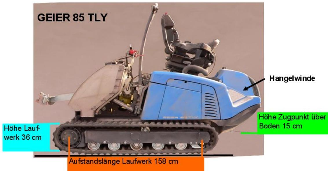
Abb. 18: Seitenansicht der Geier 85TLY mit Dreipunkthebewerk und Herbizidspritzeinrichtung. Da die Bauweise ähnlich der 60TLY ist, weist die 85TLY in der gleichen Ausstattung mit Hebewerk ohne Anbaugeräte eine fast identische Gewichtsverteilung von 75 % vorn und 25 % hinten auf. Wie auf der Abbildung ersichtlich, verfügt die Geier 85TLY über eine sehr straffe Laufwerksfederung, die bei geringer Heckbelastung in der Ebene das hintere Laufwerk vom Boden abhebt.
