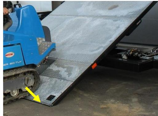
Abb. 33: Die Abstützung der Drehkippritsche beim Trägerfahrzeug der Firma Piesporter Landmaschinen erfolgt durch Auflage der Drehkippritsche auf den Weg bzw. Wegrand
