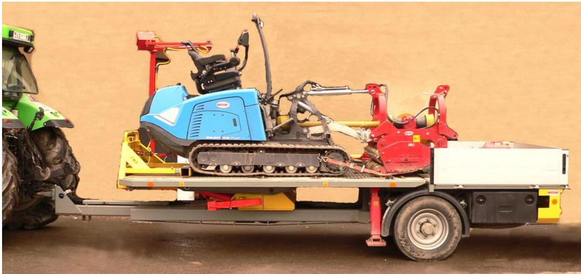
Abb. 44: Das KMS-Rinklin-RMS-Trägerfahrzeug mit einer Drehpritsche auf Höhe der Transportpritsche war mit einer Länge von 6,38 m und 3,2 t Masse das mit Abstand größte und schwerste RMS-Trägerfahrzeug, das getestet wurde. Das Trägerfahrzeug verfügt über einen verstellbaren Überfahrerschutz mit unterschiedlichen Anschlagpunkten für das Seil der Hangelwinde.
