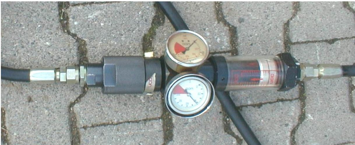
Abb.66: Kombi-Gerät zur Messung des Leistungsbedarfs im Hydraulikkreislauf
