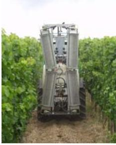
Diese bewährte Technik auf hohem Niveau zeichnet sich schon seit Jahren durch überdurchschnittliche applikationstechnische Leistungen aus. Um ein sauberes Luftprofil zu ermöglichen, müssen die Düsenstationen jedoch außerhalb des Luftstromes positioniert sein. In dem eine Teilbreite in mehrere separat regelbare Segmente unterteilt wird, leitet diese Technik in Verbindung mit der elektronischen Luftstromregelung (EOL) eine neue Epoche der Gebläseentwicklung ein.
