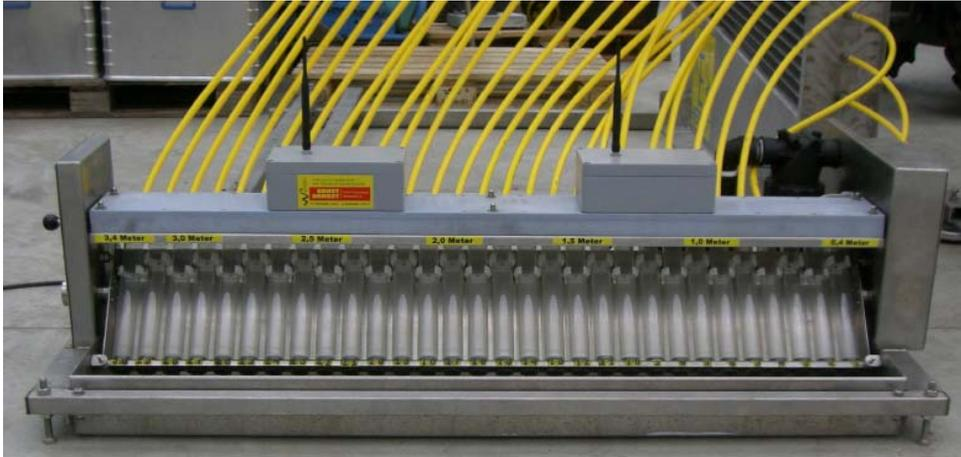
Abb.42: Vertikalverteilungsmessstand, Messeinheit
