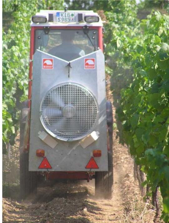
Abb. 6: modernes Axialgebläse mit Luftleitsystem (ZA 24)
