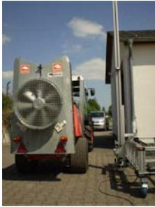
Moderne Axialgebläse zeichnen sich durch ein wirksames Luftleitsystem und durch ein möglichst weit oben liegendes Laufrad aus. Dadurch wird sowohl die Teilbreitensymmetrie als auch die Vertikalverteilung deutlich verbessert. Luft- und Flüssigkeitsverluste halten sich in Grenzen. Geräte dieser Bauart sind in die 90 %-Abtriftminderungskategorie eingestuft. Sie sind im deutschen Weinbau sehr weit verbreitet und verkörpern ein zeitgemäßes Pflanzenschutzgerät auf angemessenem Leistungsniveau.
