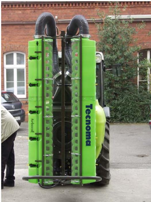
Abb.11: Radialgebläse mit Luftverteilungssystem
