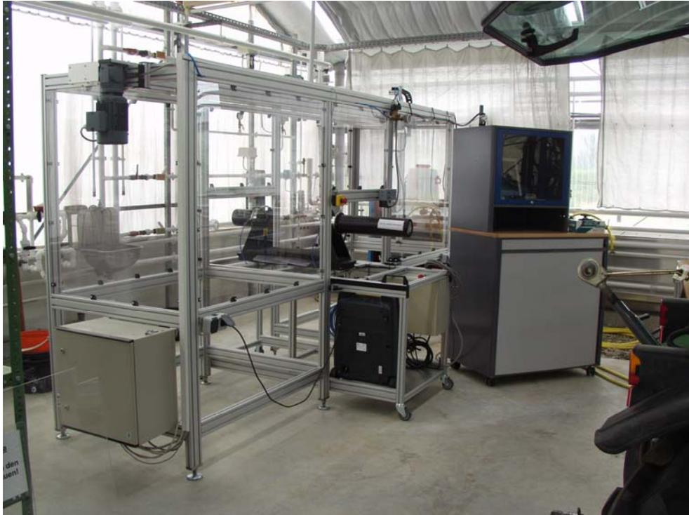
Abb.3: Tropfengrößenmessung durch Laserdiffraktion
