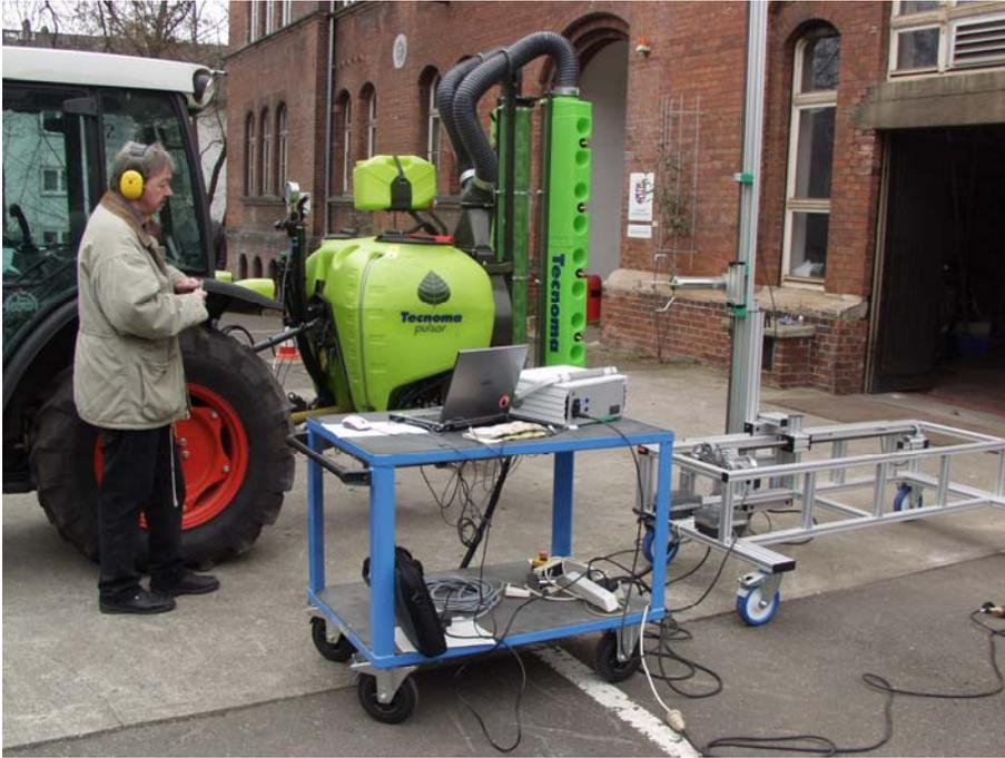
Abb.16: Messstand zur Erfassung der Luftprofile
