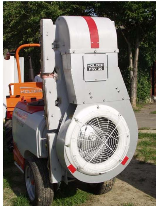
Abb.12: Diffusor-Radialgebläse Holder PSV30 Turbocoll von Tecnomat
