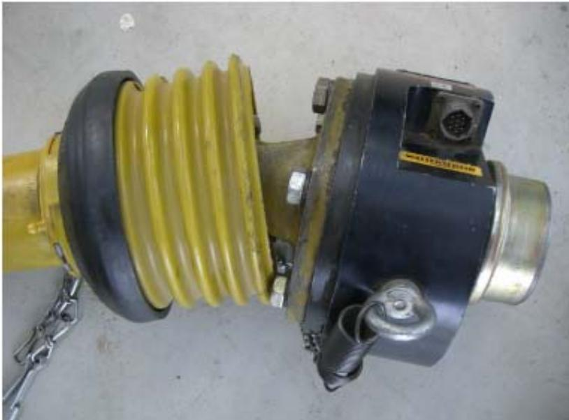
Abb.65: Drehmoment-Messwelle zur Messung des Leistungsbedarfs
