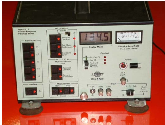
Abb. 7: Human-Schwingungsmesser Typ 2512 (Fa. Brüel & Kjaer)
