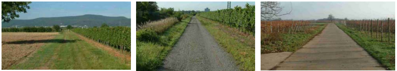
Abb. 22: Weg-Fahrbahnen zur Messung der Belastung des Fahrers durch hochfrequente Schwingungen (1 – 80 Hz) mit dem Fendt 207 V: Grasweg (links), Schotterweg (Mitte), Beton-/Asphaltweg (rechts)
