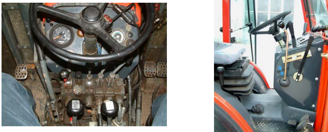
Abb. 30: Steuerventilhebel beim Dexheimer 345 SC (links) und 480 Si (rechts)
