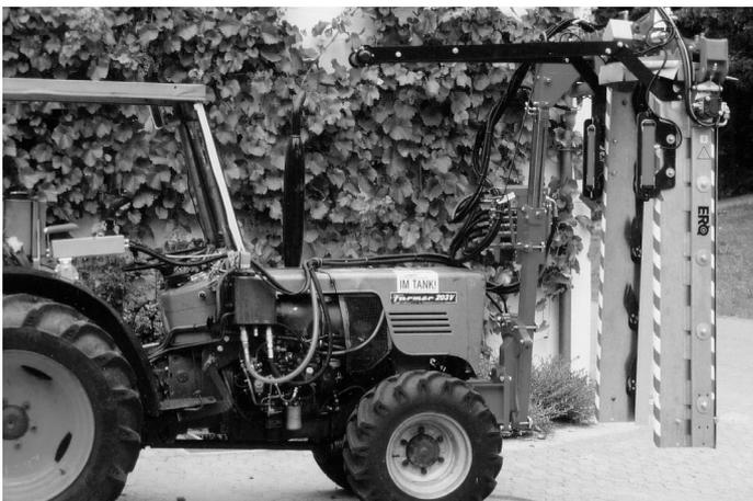
Abb. 1: Weinbautraktor mit angebaute Laubschneidegeräte und automatischer Steuerung
