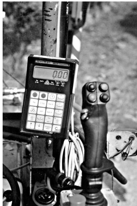
Abb. 3: Joystick-Bedienung für die Komfortsteuerung der Firma ERO
