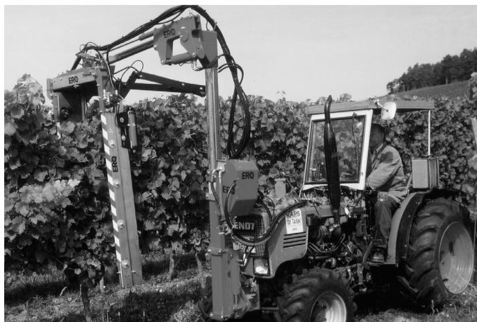
Abb. 7: Laubschneidegerät mit automatischer Steuerung im Einsatz
