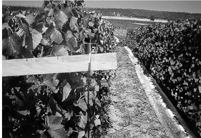
Abb. 9: Position eines Lichtsensors zur Erfassung der Referenzstrahlung horizontal über der Rebzeile
