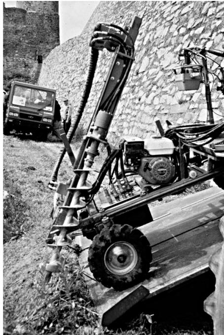
Abb. 19: Erdbohrer auf Geräteträger mit hydraulischem Antrieb
