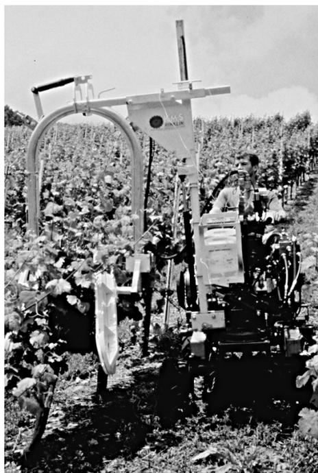
Abb. 20: Hydraulisch angetriebener und verstellbarer Heftgeräte-Prototyp
