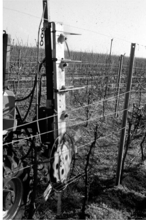
Abb. 27: Laubschneider schneidet in die Zeile ragendes Altholz
