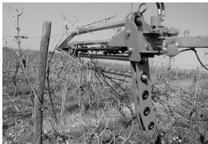
Abb. 5: Ero Vorschneider beim Anschnitt einer langen Rute. Der Drahtschutz wurde verbessert durch Führung des Drahtes über dem oberen Stab
