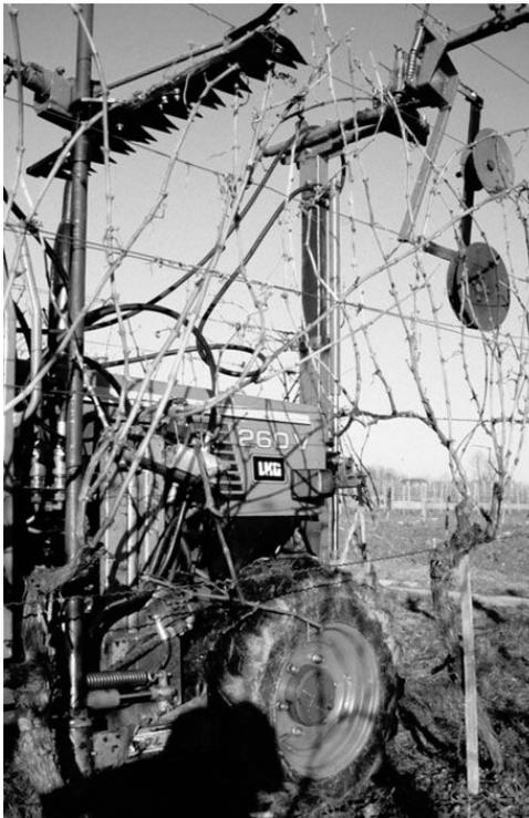
Abb. 28: Drahtablegegerät kombiniert mit einem Messerbalken
