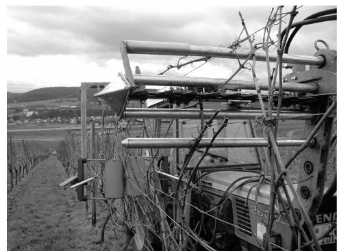
Abb. 29: Neues Drahtablegegerät System KH kombiniert mit Vorschneider System KH
