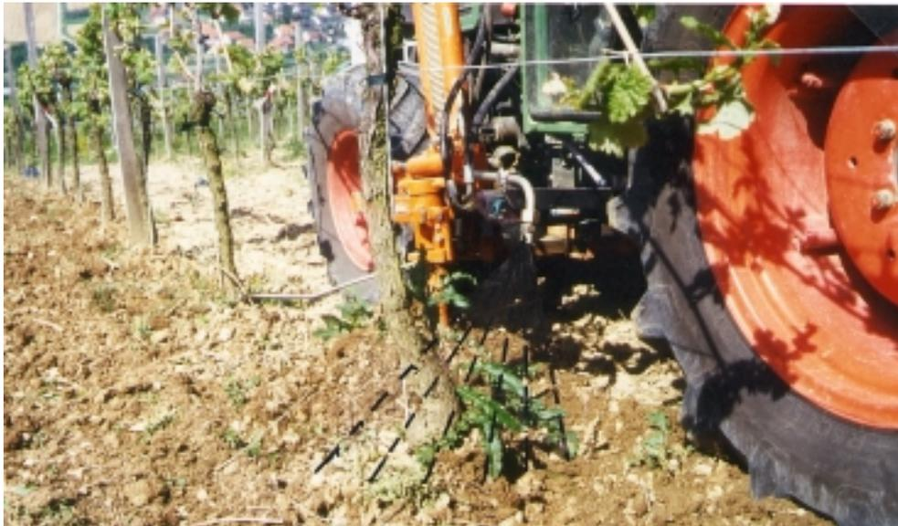
Abb. 9: Punktspritzeinrichtung in Kombination mit dem Stockräumer im Einsatz
