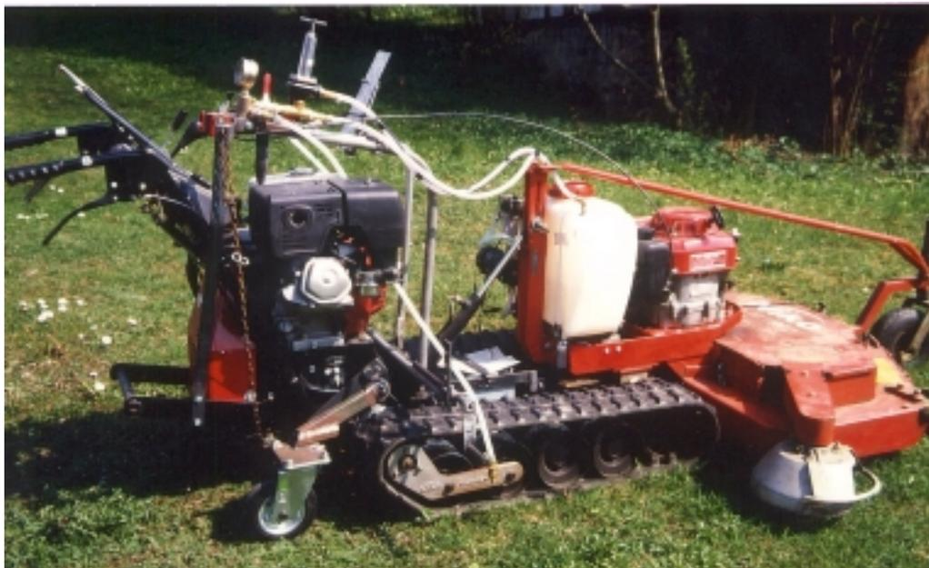
Abb. 18: Handgeführte Kleinraupe mit aufgebautem Bandspritzgerät und Kreiselmulchgerät
