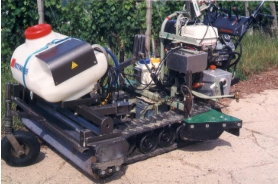
Abb. 20: Handgeführte Kleinraupe mit aufgebautem Streichverfahren
