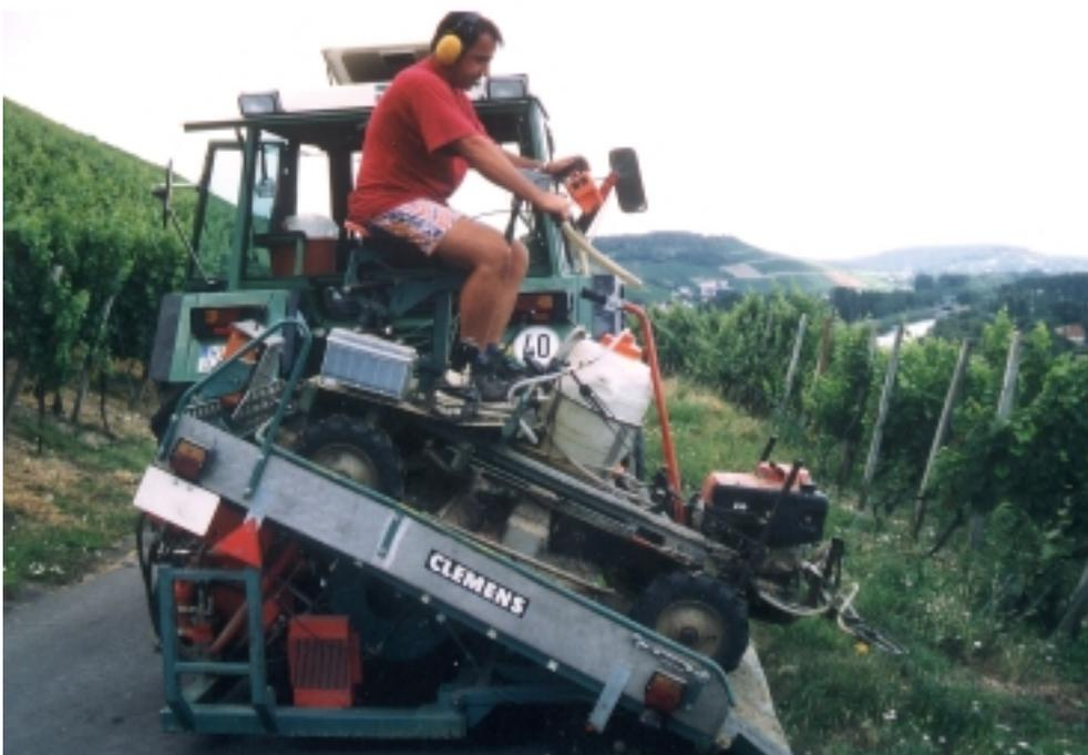
Abb. 17: Steillagen-Mechanisierungs-System (SMS) mit Bandspritzgerät und Kreiselmulchgerät
