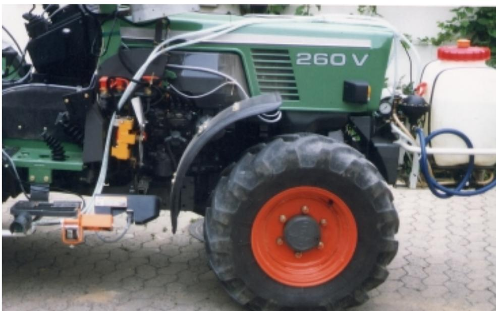
Abb. 10: Optoelektronische Unkrautererkennung im Zwischenachsenanbau
