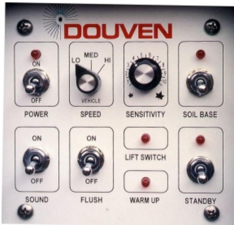
Abb. 11: Bedienungseinheit einer optoelektronischen Unkrautererkennung
