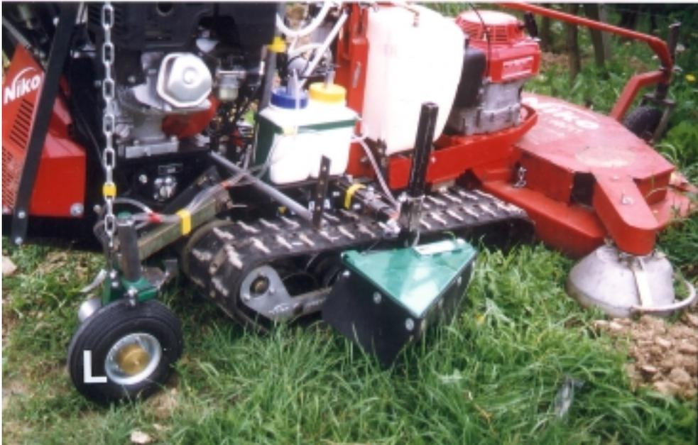
Abb. 19: Handgeführte Kleinraupe mit aufgebautem ULV-Verfahren und Kreiselmulchgerät
