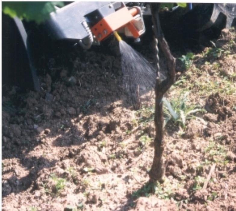
Abb. 41: Optoelektronische Unkrauterkenennung im Einsatz
