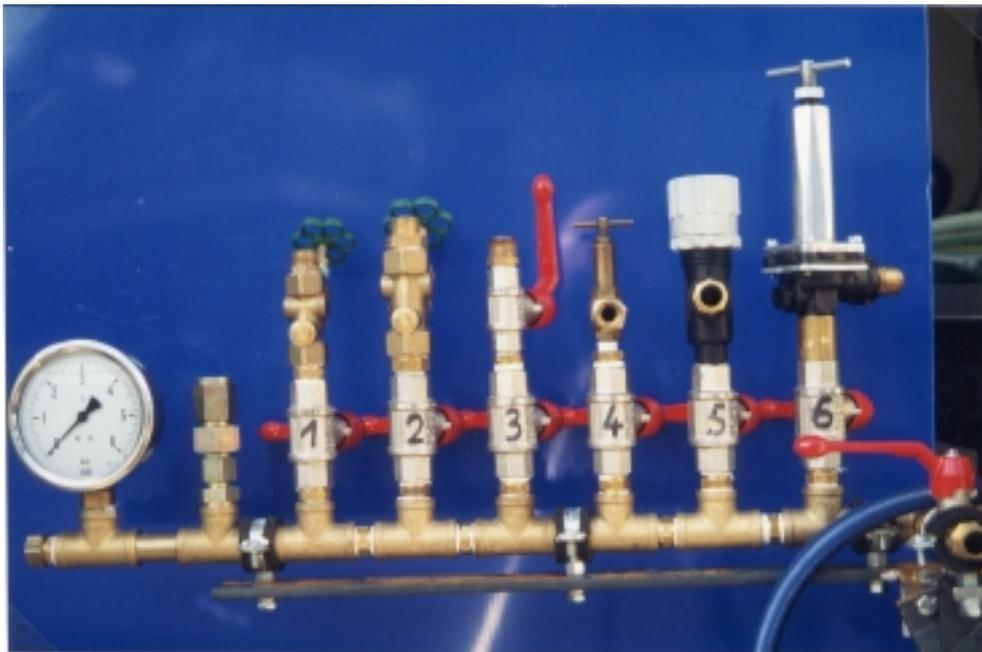
Abb. 3: Unterschiedliche Druckregleinrichtungen am Prüfstand
