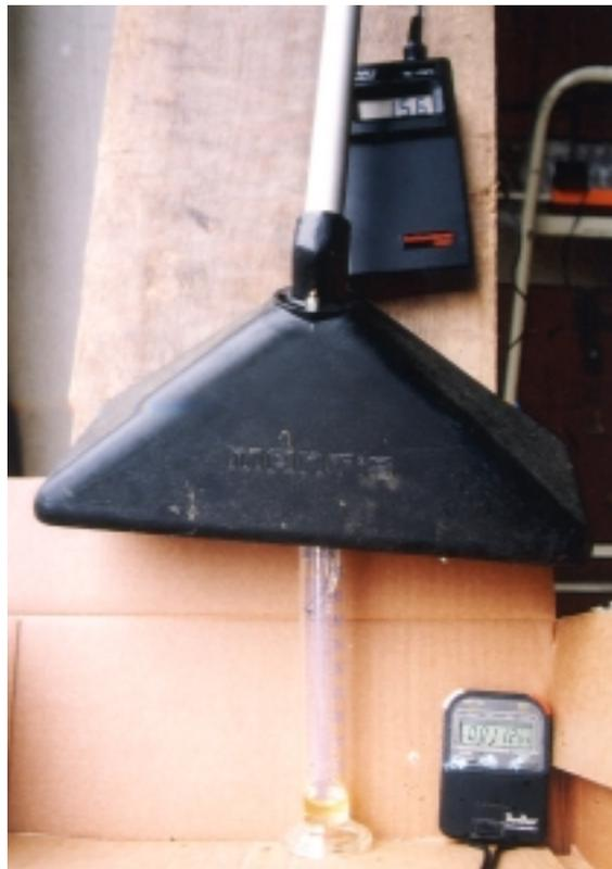
Abb. 30: Ermittlung der Austragsmengen beim ULV-Verfahren bei unterschiedlichen Temperaturen
