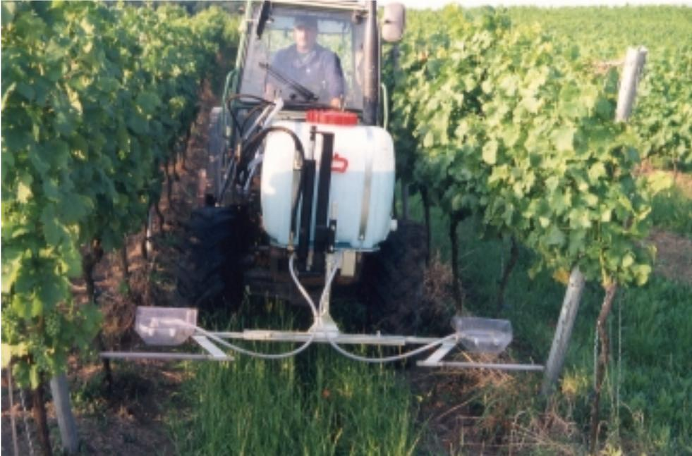
Abb. 1: Frontseitig angebautes Band-Spritzgerät im Einsatz
