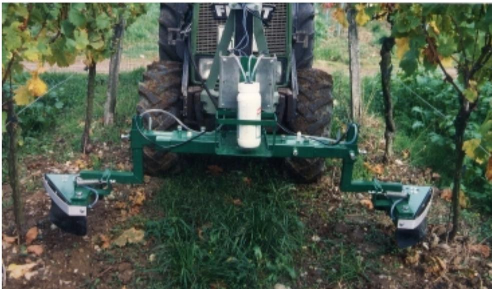
Abb. 15: ULV-Verfahren im Frontanbau am Weinbauschlepper
