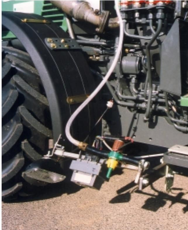
Abb. 14: Aufgelöste Bauweise einer optoelektronischen Unkrauterkennung
