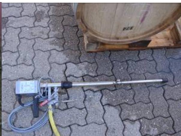
Sprühlanze mit Drehkopf des Verfahrens
