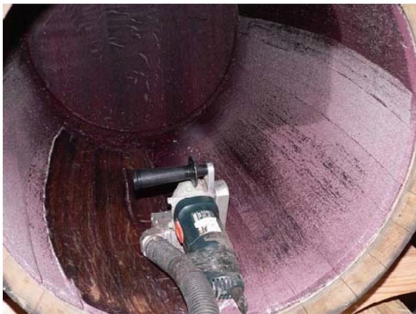
Aushobeln mit einer Elektrofräse
