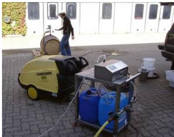
Hochdruckreiniger, Steuerung und Lösungen
