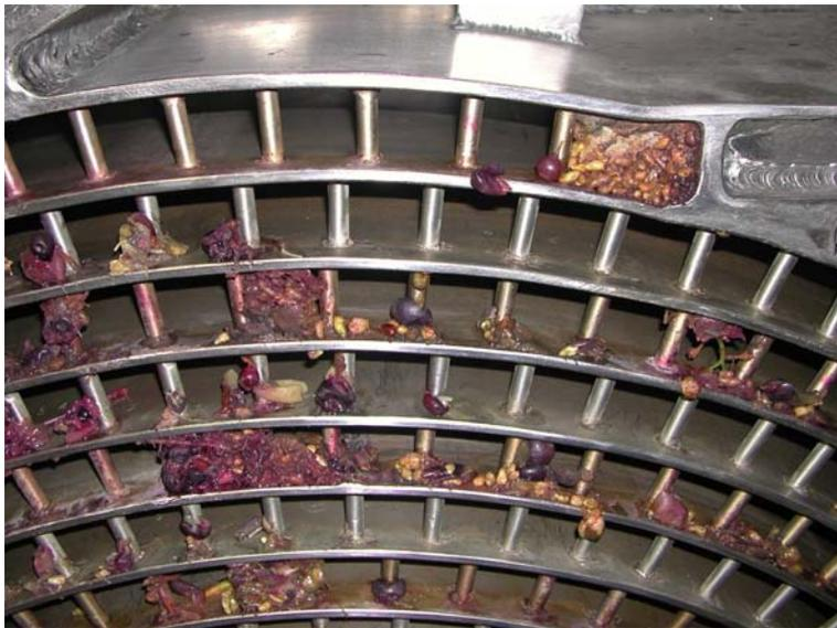
Abb. 4.8: Spiralwärmetauscher – detail – zum direkt regenerativen Wärmetausch
