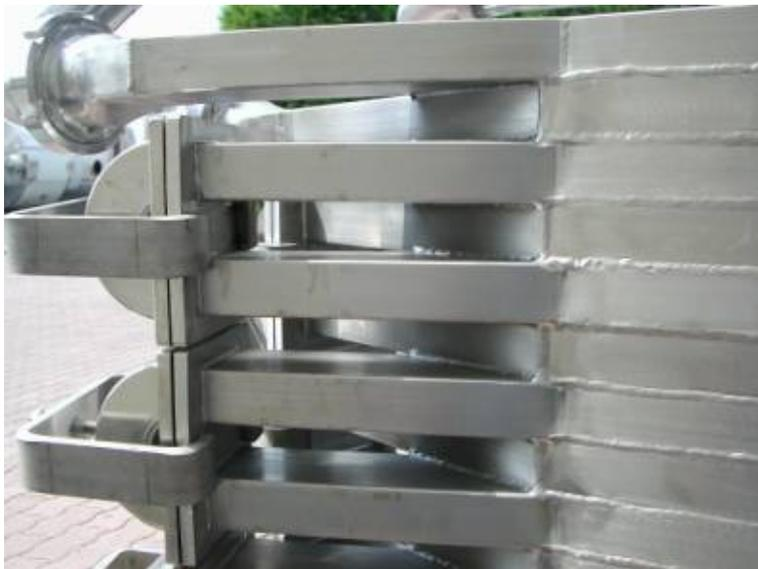
Abb. 4.9: Wärmetauscher (Fa. Becker) zum direkt regenerativen Wärmetausch
