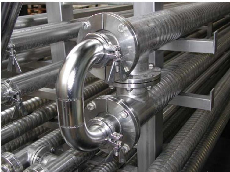
Abb. 4.11: Röhrenwärmetauscher zum indirekt regenerativen Wärmetausch
