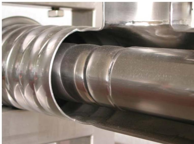
Abb. 4.12: Röhrenwärmetauscher Ausschnitt Kernrohr (innen) und Mantelrohr (außen)
