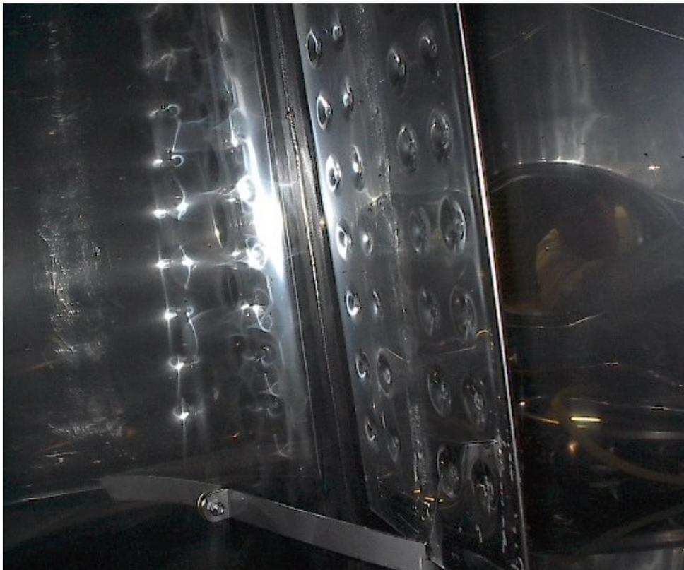
Abb. 29: Darstellung Wärmeüberträgerplatte und deren Einbau in die Tanks
