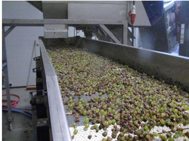
Abb. 9: Langer Rütteltisch mit großem Sieb und guter Verteilung (Quelle: DLR Mosel)
