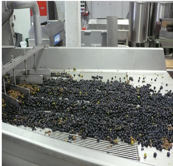
Abb. 10: Kurzer Rütteltisch mit kleinem Sieb und schlechter Verteilung (Quelle: DLR Mosel)
