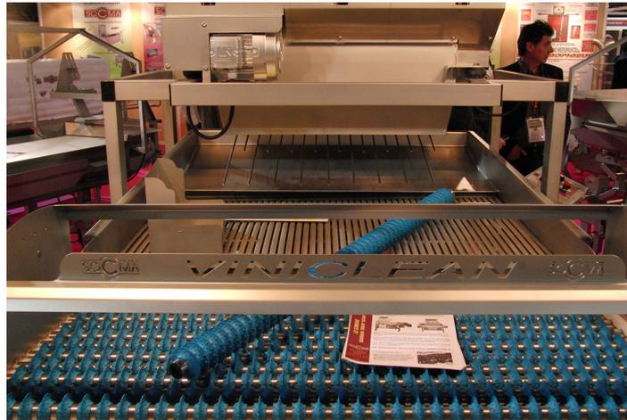
Abb. 4: Socma Viniclean hinter einem Entrapper (Quelle: DLR Mosel)
