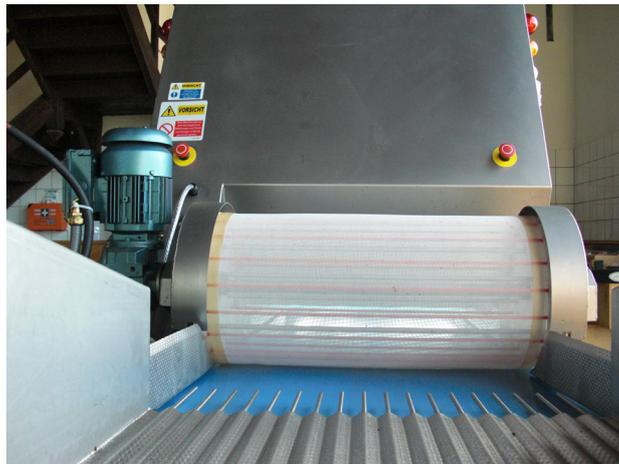
Abb. 11: Glattes Band mit angetriebener Stabilisatorrolle (Quelle: DLR Mosel)
