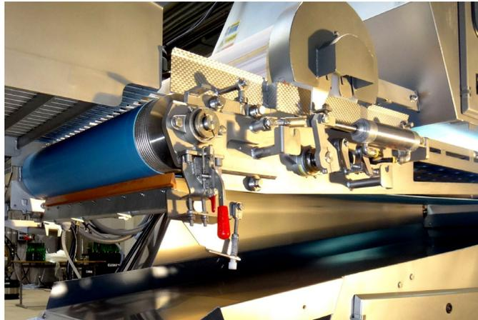
Abb. 40: Glattes Band mit Schaber zur Reinigung (Quelle: DLR Mosel)
