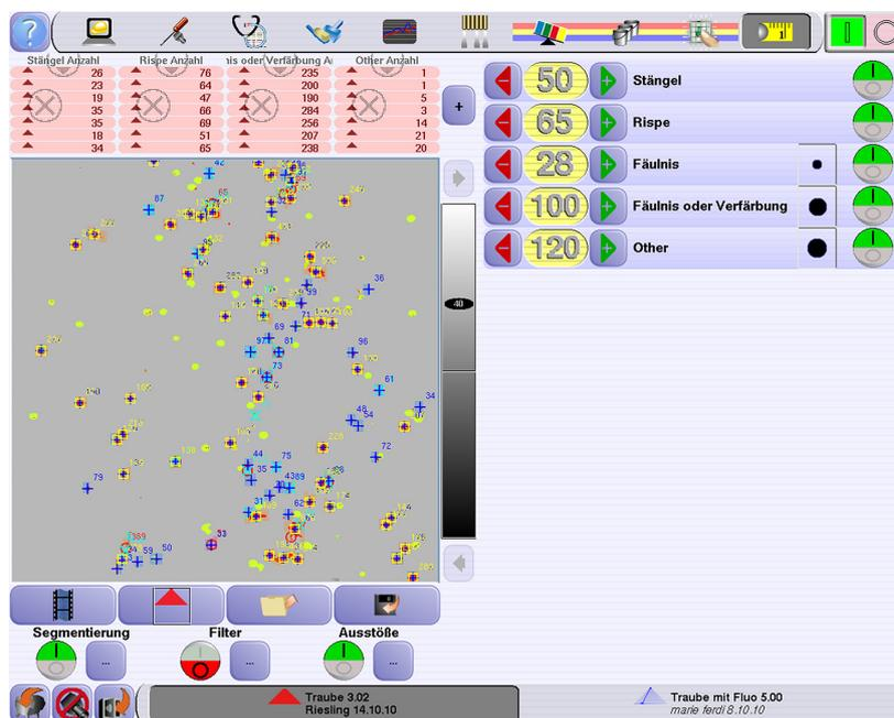
Abb. 7: Benutzbildschirm einer Sortiermaschine (links das Kontrollbild der Softwareerkennung mit den zur Ausschleusung markierten Beeren, rechts die eingestellten Parameter) (Quelle: DLR Mosel)
