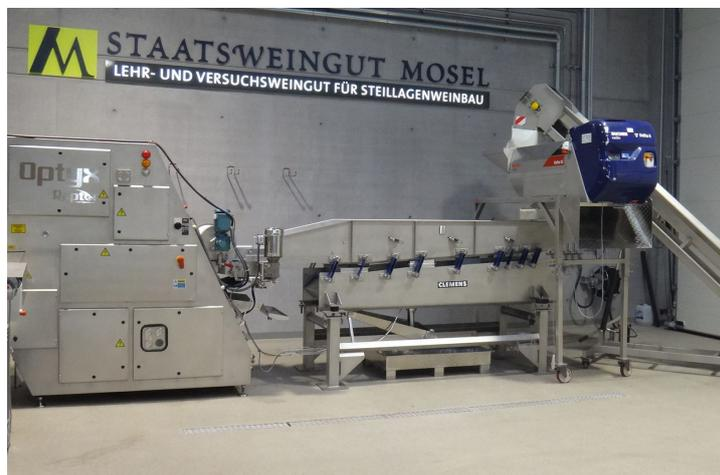
Abb. 18: Clemens/Key Sortieranlage am DLR Mosel (Quelle: DLR Mosel)
