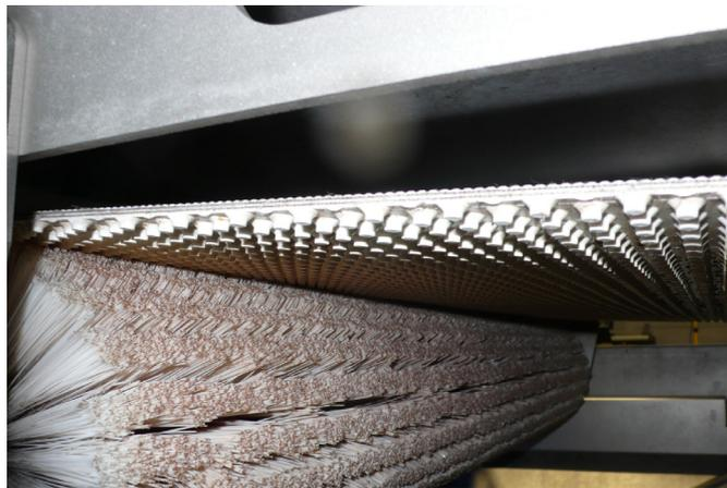
Abb. 41: Noppenband mit Bürste zur Reinigung (Quelle: DLR Mosel)
