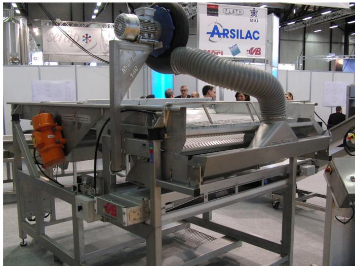
Abb. 3: Mistral Gebläsesystem mit vorgeschaltetem Sortiertisch (Quelle: DLR Mosel)
